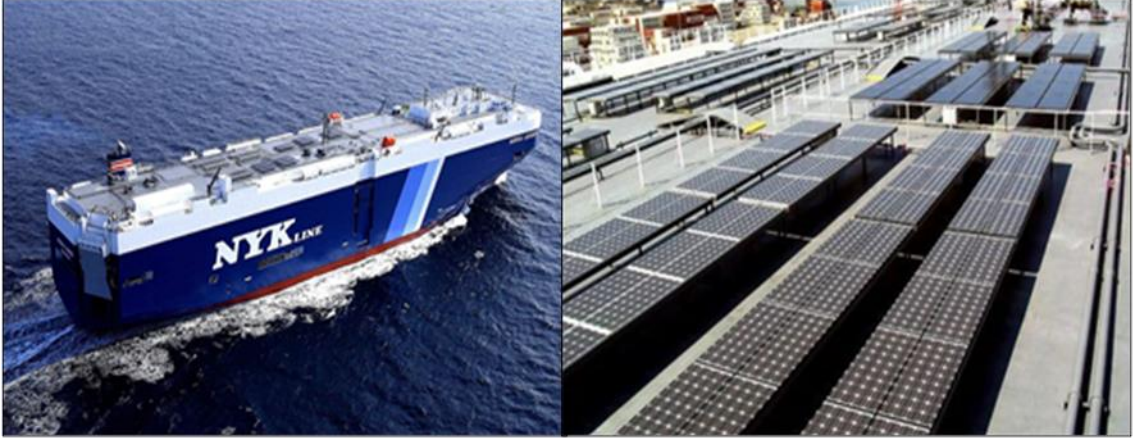
Şekil 4.2 M/V Auriga Leader gemisi fotovoltaik enerji uygulaması
