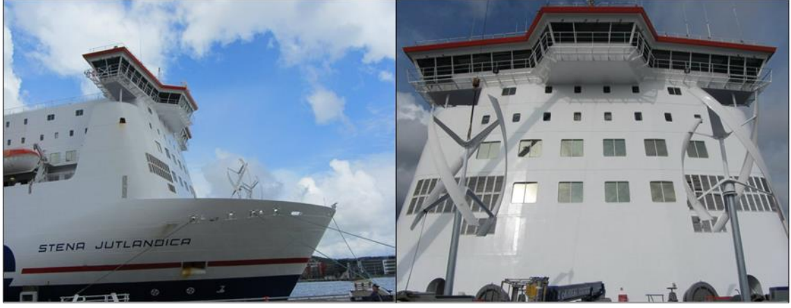
Şekil 4.3 M/S Stena Jutlandica gemisi rüzgâr türbini uygulaması
