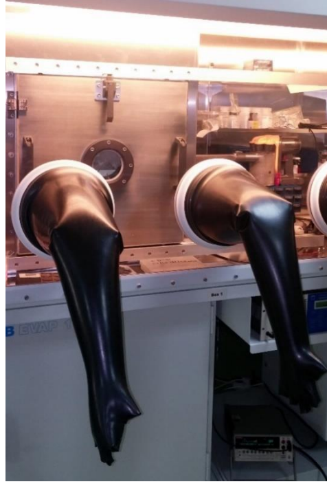
Şekil 4. 3 TÜBİTAK FESLAB’ da metal elektrot kaplamak için kullanılan termal buharlaştırıcı
