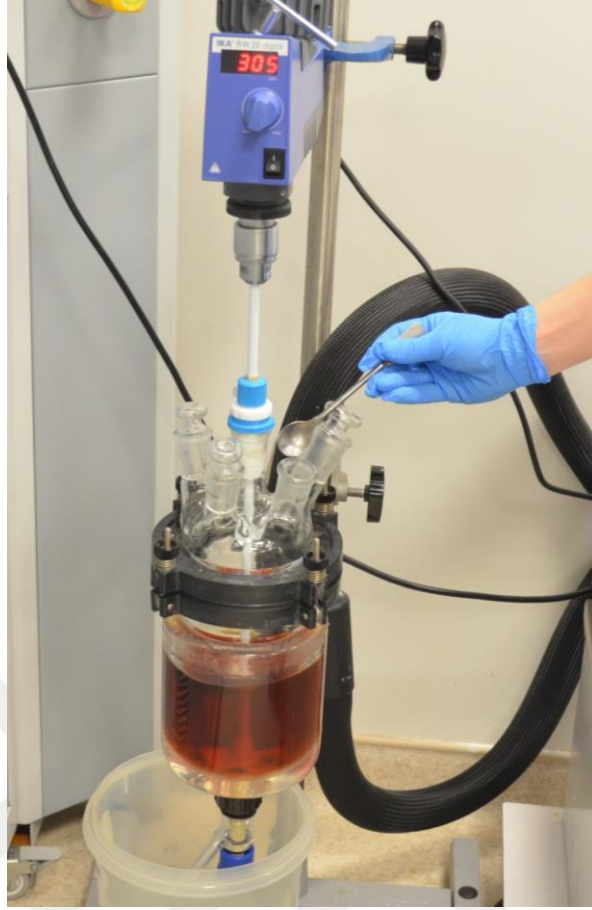
Şekil 3.1 AyDOD'un esterleştirilmesi reaksiyonlarında kullanılan düzenek
