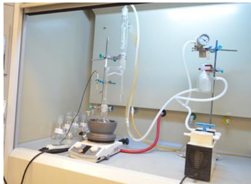
Şekil 3.5 SİLBOR sentezi reaksiyon düzeneğinin gösterimi
