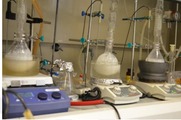
Şekil 3.4 Dealüminasyon ve desilikasyon reaksiyon düzenekleri
