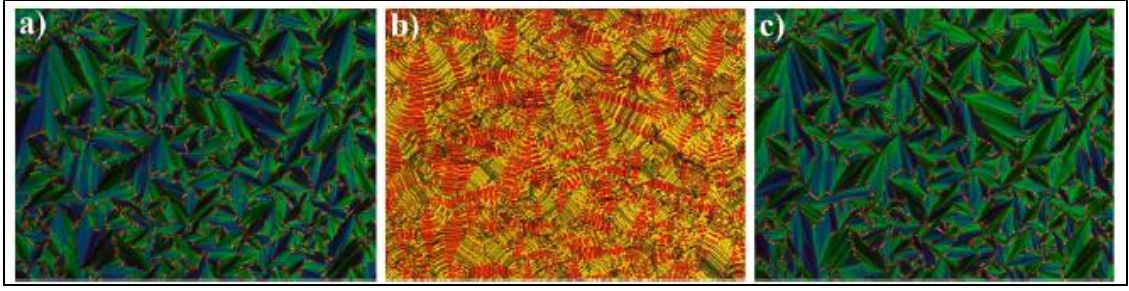
Şekil 5.161 DC voltajı altında 113 °C'de Bileşik 18b 'nin SmC* mesofazının tekstürel değişimleri; a) +10 V, b) 0 V ve c) -10 V
