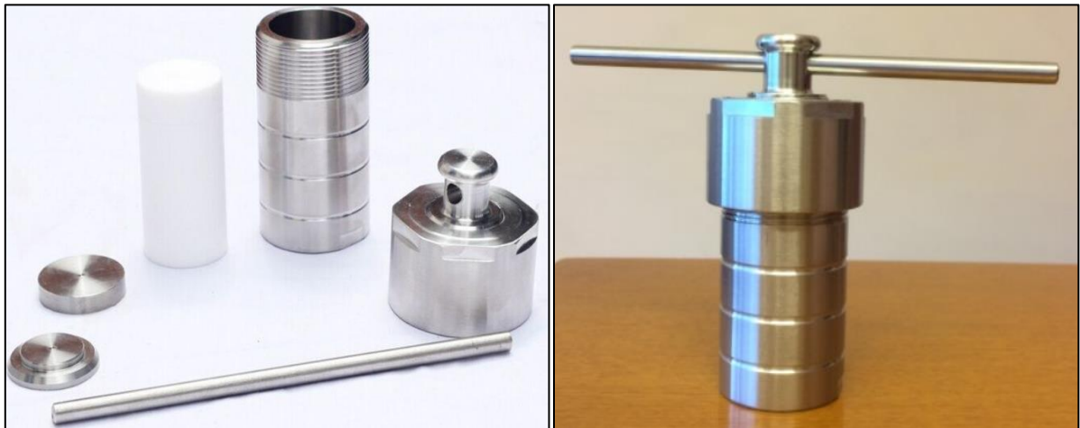
Şekil 3. 6 Hidrotermal sistemlerde kullanılan bir reaksiyon kabının ayrı ve birleşik gösterimi
