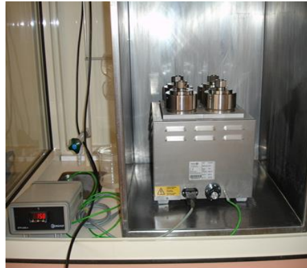
Şekil 4. 15 Nano-TiO 2 kompozitlerin sentezinde kullanılan hidrotermal reaktörün gösterimi
