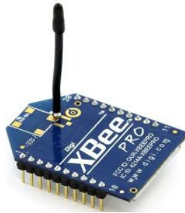
Şekil 3.9 XBee Kablosuz Haberleşme Modülü [21]
