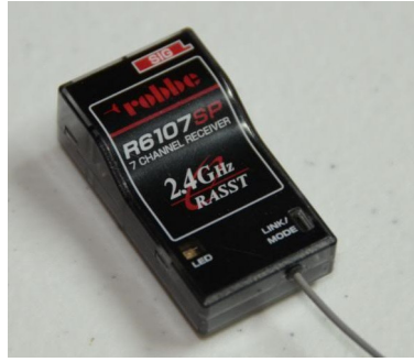
Şekil 3.12 Robbe 2.4 Ghz Kumanda Alıcı [24]
