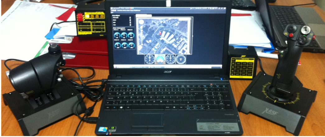
Şekil 6.2 Hexacopter için kablosuz ağ üzerinden uzaktan kumanda platformu
