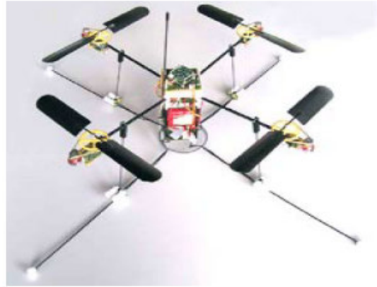
Şekil 2.4 Geliştirilen iki farklı OS4 Platformu [10]
