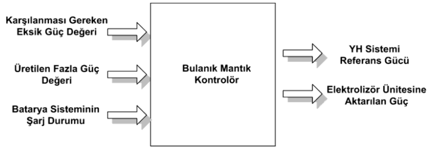
Şekil 3. 11 Oluşturulan bulanık mantık tabanlı enerji yönetimi stratejisinin blok diyagramı
