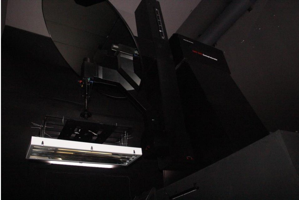
Şekil 3.21 Testlerin gerçekleştirildiği döner aynalı gonyofotometre sistemi
