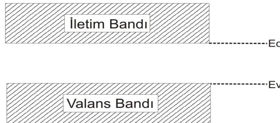
Şekil 2.1 Saf ve kusursuz bir kristalin enerji bant diyagramı
