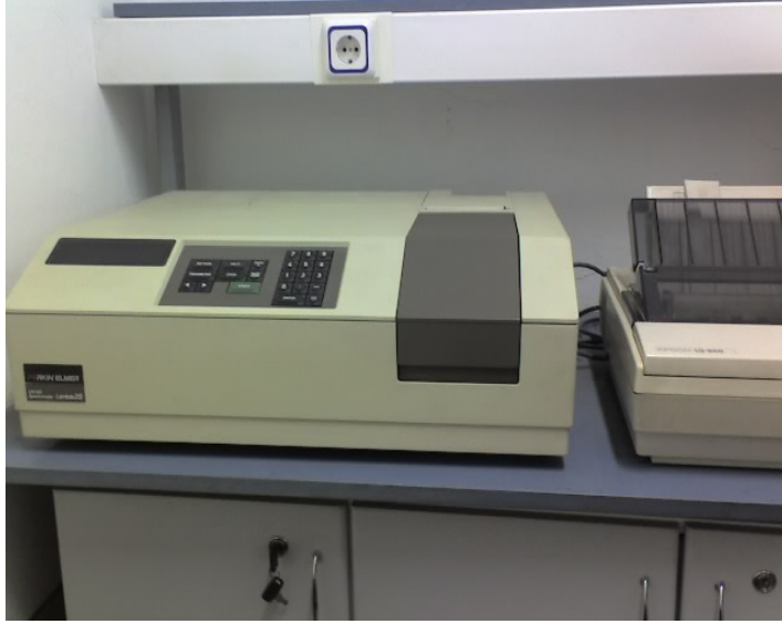
Şekil 3.7 Y.T.Ü Fizik Bölümü Katihal Elektronik Laboratuvarında bulunan UV/VIS Lambda 2S” Perkin Elmer spektrometresi.
