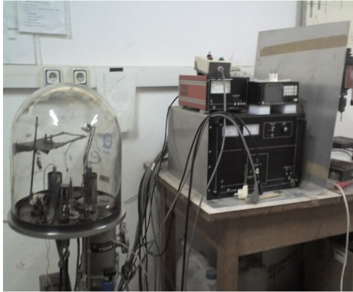
Şekil 3.3 Y.T.Ü Fizik Bölümü Katıhal Elektronik Laboratuvarında bulunan elektron demeti buharlaştırma vakum sistemi.
