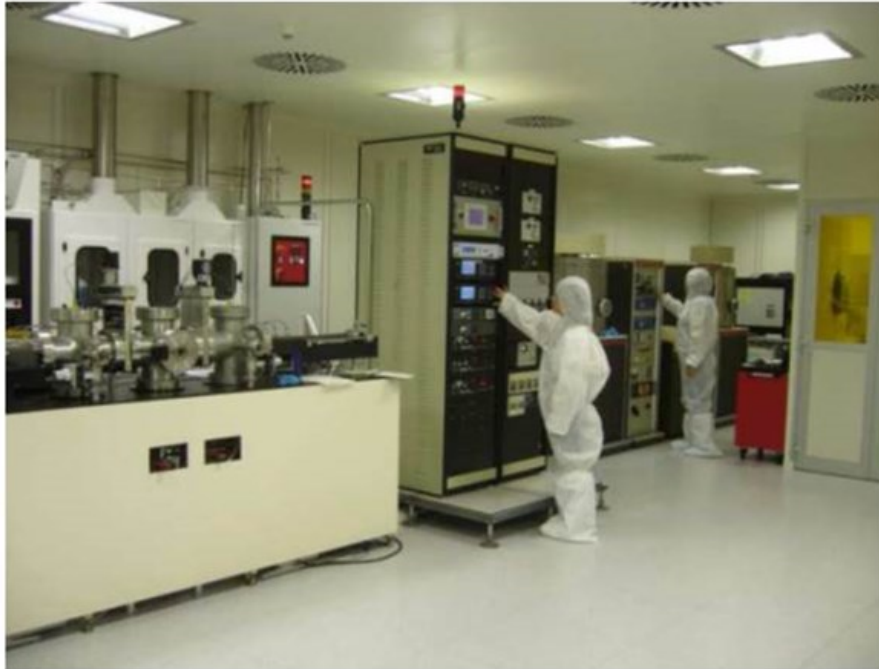
Şekil 3.8 UME'de temiz odasında bir görünüm. Sol tarafta PECVD, sağ ileride TCO ve metalizasyon kaplama sistemleri görülmektedir.
