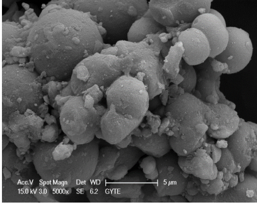
Şekil 7.17 N-1 tozuna ait SEM görüntüsü
