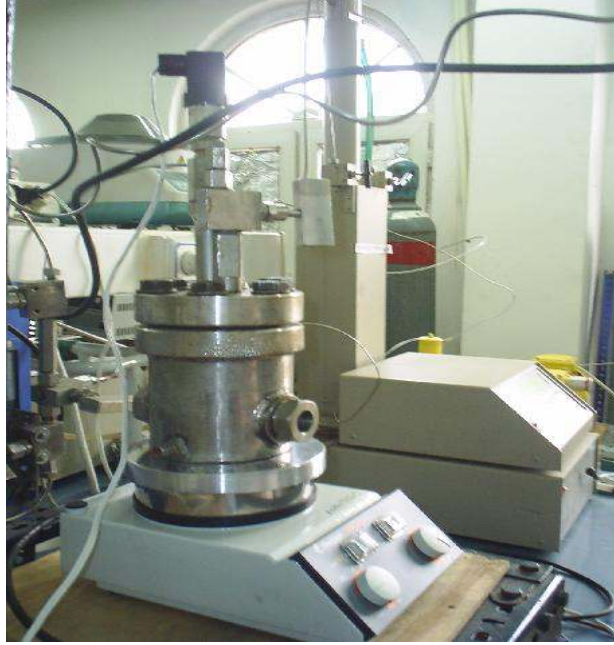
Şekil 5.8 Bulutlanma noktası deneylerinde kullanılan hücre ve ekipmanları
