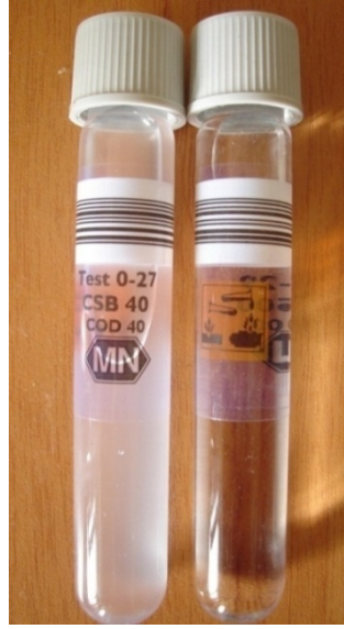
Şekil 4.38 o,o-dimetil-2,2-diklor-vinil fosfat emülsiyonunun SCWO öncesi (solda) ve sonrasındaki (sağda) görünümü
