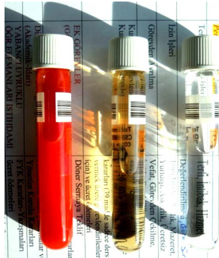
Şekil 4.1 DO25 model atık suyunun orijinal hali ile iki ayrı deney koşulunda elde edilen sıvı ürünlerin (deney no. 1 ortada, deney no. 30 sağda) fotoğrafı
