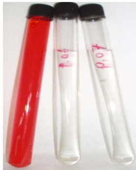
Şekil 4.16 Tekstil boyahane atık suyunun orijinal hali ve iki farklı koşuldaki süperkritik su oksidasyonu (Deney no. 6 ve Deney no. 7) sıvı ürününün görünümü
