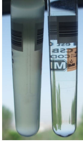
Şekil 4.27 Peynir altı suyunun süperkritik su oksidasyonu ile arıtma öncesi (solda) ve sonrasındaki (sağda) görünümü
