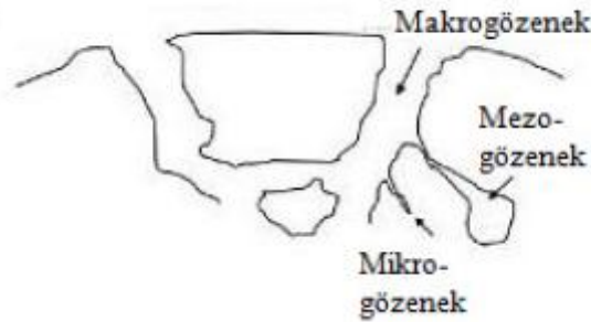
Şekil 3.6 Adsorbanların gözenek tipleri [49]
