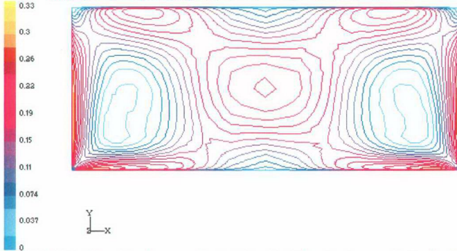
Şekil Ek 2.6 (6x2,5x6m) boyutlu odanın merkezinde ( z = 3\text{m} ) tabandan tavana oluşturulan bir düşey düzlemde hız konturları (m/s) ( T_w = 37^\circ\text{C} , T_d = 15^\circ\text{C} , T_i = 25^\circ\text{C} )
