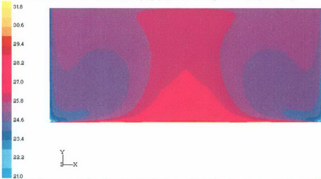
Şekil Ek 3.6 (6x2,5x6m) boyutlu odanın merkezinde ( z = 3\text{m} ) tabandan tavana oluşturulan bir düşey düzlemde sıcaklık konturları ( ^{\circ}\text{C} ) ( T_w = 37^{\circ}\text{C} , T_d = 15^{\circ}\text{C} , T_t = 25^{\circ}\text{C} )
