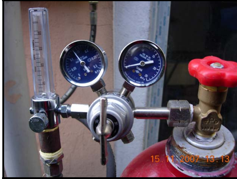
Şekil 5.8 Çift kademeli akışmetreli regülatör
