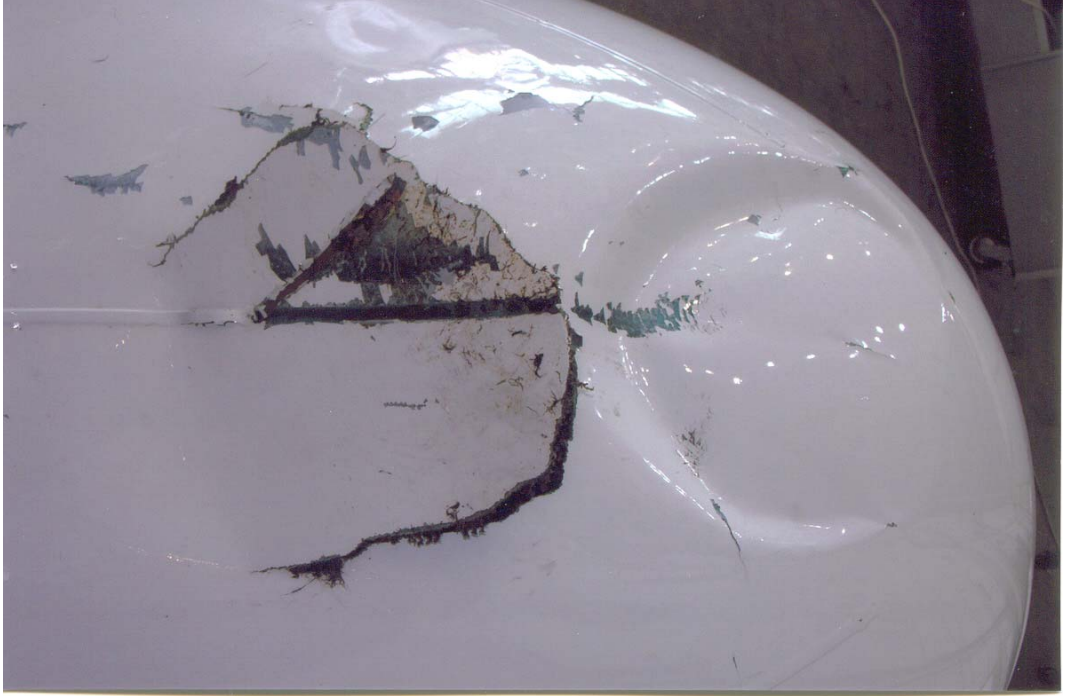
Şekil 7.105 Airbus 320 radomunun ağır hasarlanmış radomunun dıştan görünümü
