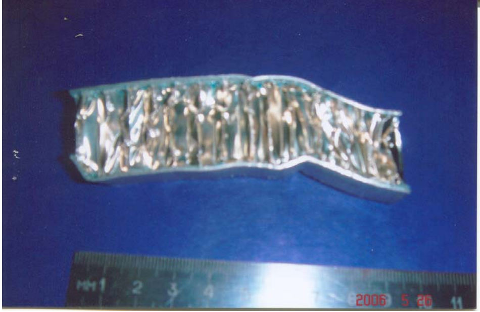
Şekil 7.2 Rijitlik hatası sonucu meydana gelmiş yapı görüntüsü
