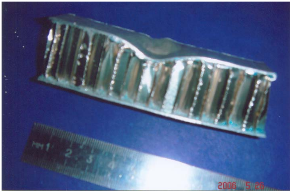
Şekil 7.7 Bölgesel basınç sonucu oluşan hasar
