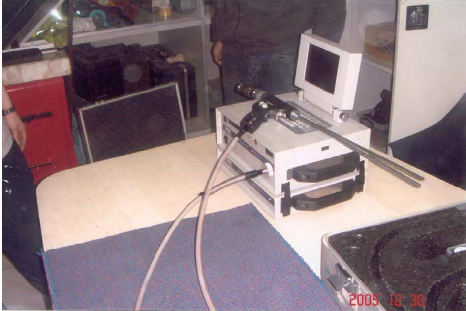
Şekil 7.42 Hatalı bölgenin baroskop cihazı ekranında gözle takip edilmesi
