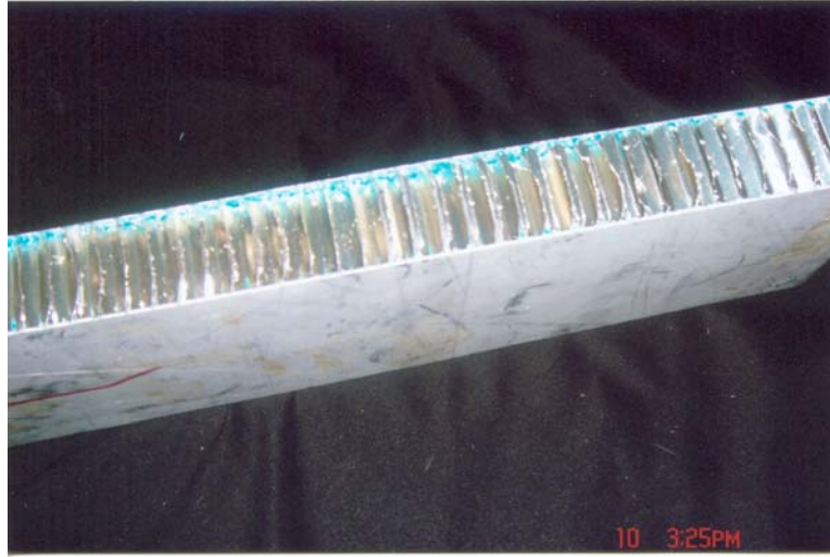
Şekil 3.17 Isıtılmış basınç altında üretilmiş metal tabaka, metal petek hücre (alüminyum) den oluşan balpeteđi kompozit malzeme
