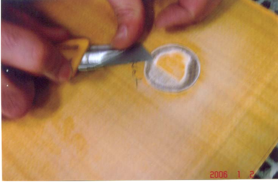
Şekil 7.57 Hasarlı tabakalar (sayısı belirli) özel kesici yardımıyla tamamen çıkarılmıştır
