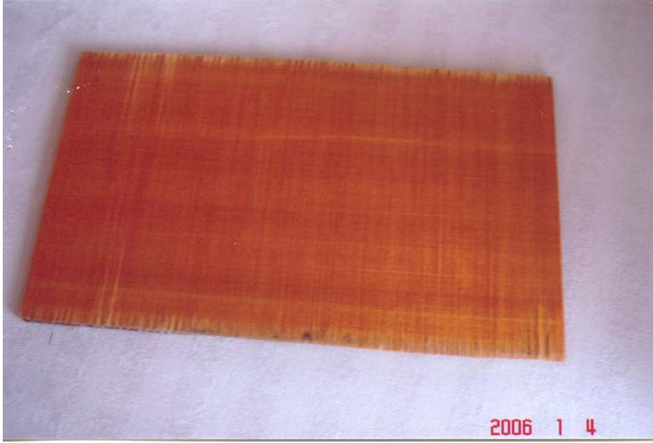
Şekil 7.35 Hasarlanmamış kompozit sandviç yapı örneği
