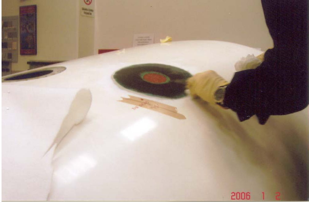
Şekil 7.90 Yüzey düzgünlüğü sağlandıktan sonra üst yüzeyler için katların uygulanması başlamıştır
