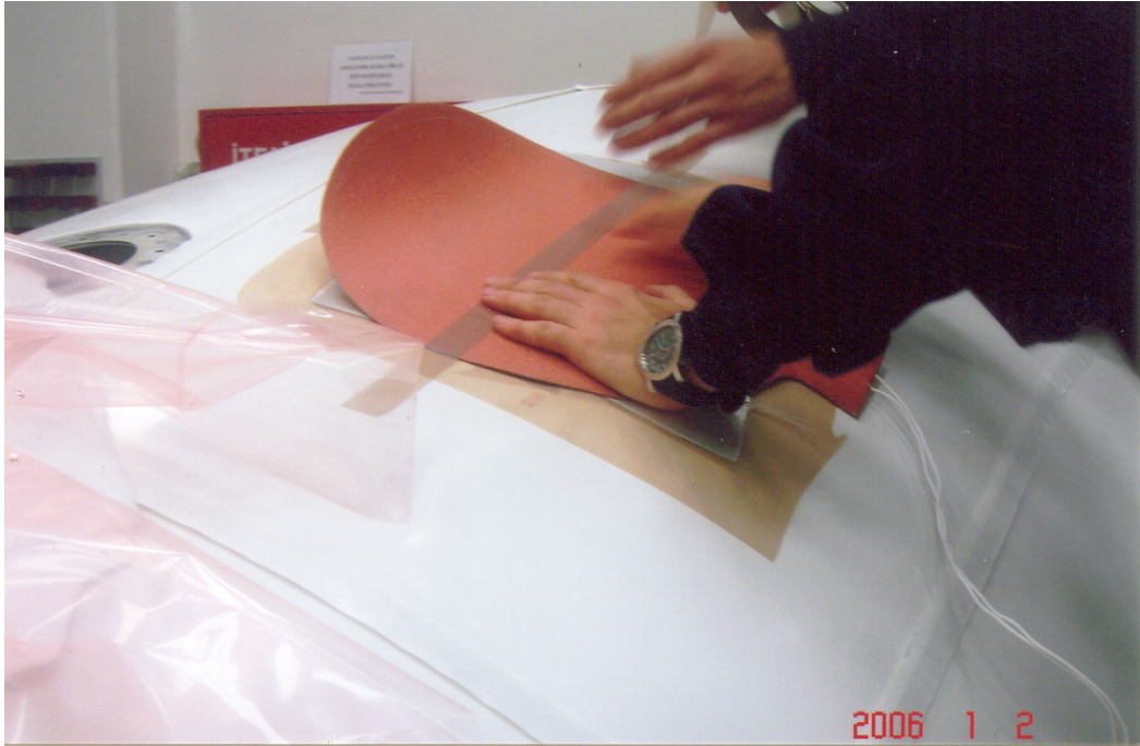
Şekil 7.93 Tamir parçası vakum ve kür işleminden önce ısı battaniyesine alınmıştır
