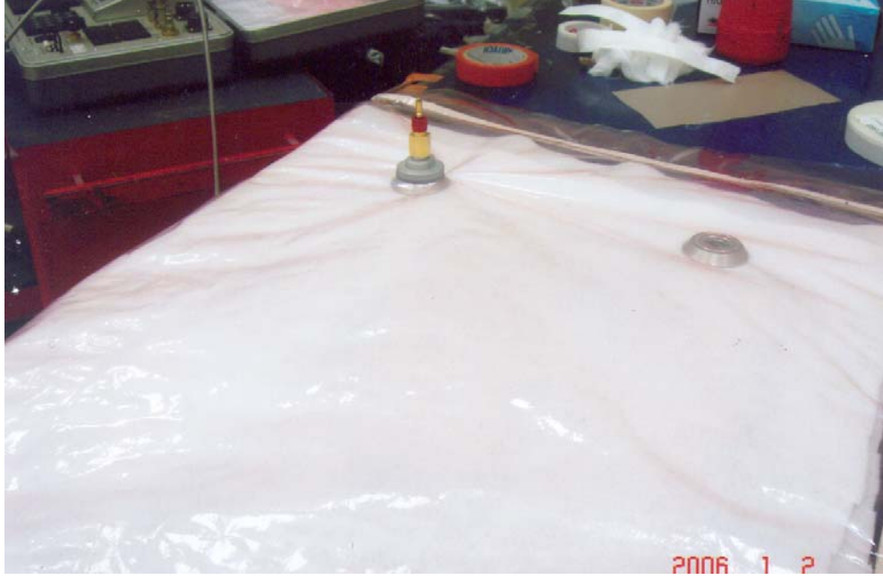
Şekil 7.71 Tamir edilen malzeme tekrar vakum torbasına alındı. 150°F sıcaklıkta yaklaşık 120 dakika kür edildi. Vakum torbasının gerekli kaçak kontrolleri yapıldı
