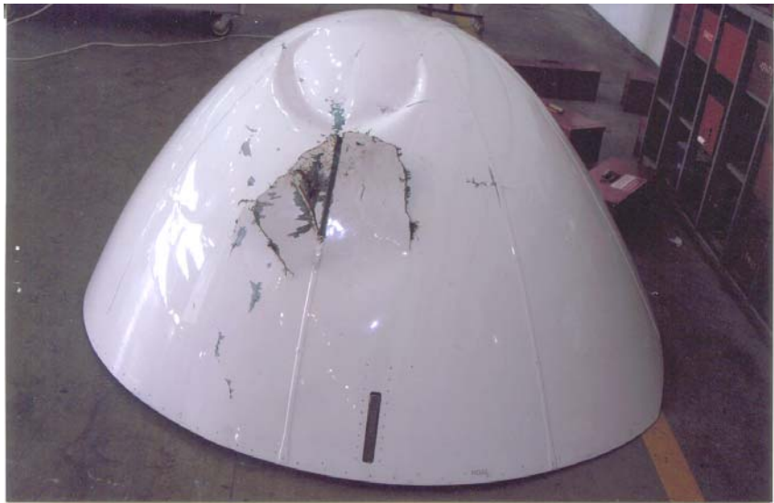
Şekil 7.104 A 320 uçağının hasara uğramış radomu
