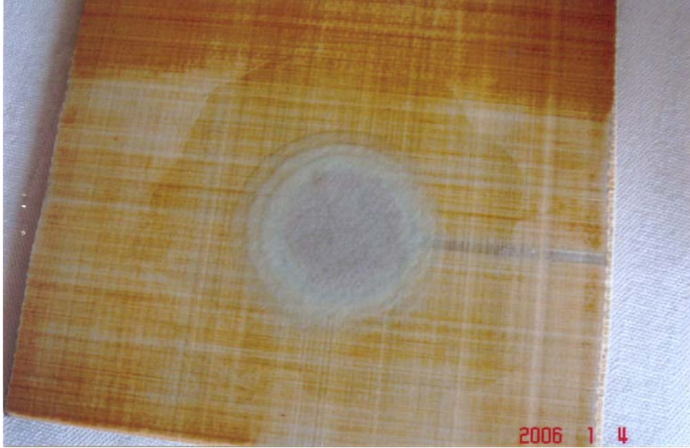
Şekil 7.72 Tamir vakum torbasından çıkarıldı. Tamirin gözle ve metal parayla yapılan tap testinde mükemmel bir şekilde bitirildiği gözlemlendi
