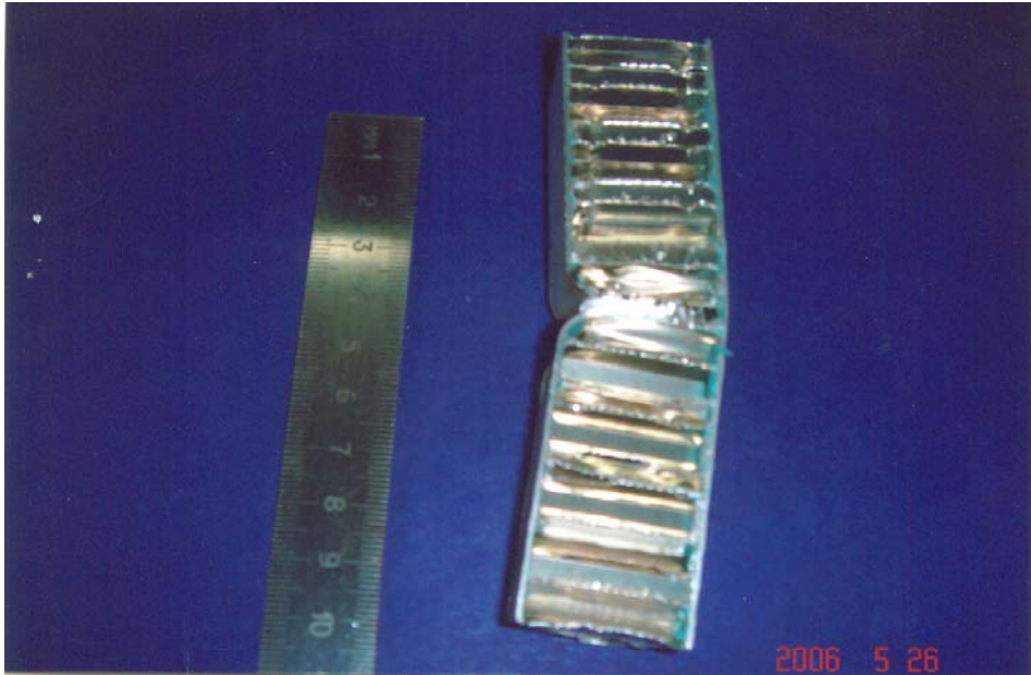
Şekil 7.3 Panel burkulması sonucu meydana gelen kompozit yapı
