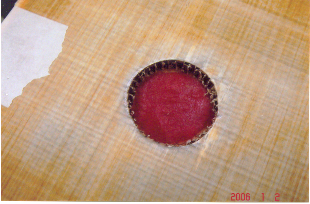
Şekil 7.77 Tamir hücresi bir yerde hazır hale getirildi. Yapıştırıcı filmi yüzeye tatbik edildi
