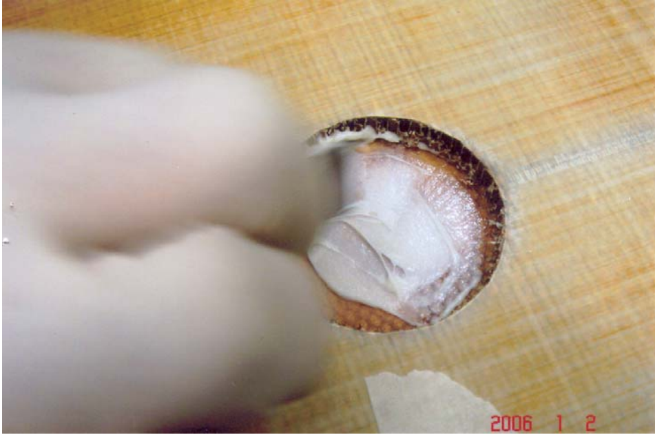
Şekil 7.64 Dolgu yapıştırma maddesi karıştırılarak tamir bölgesine sürüldü
