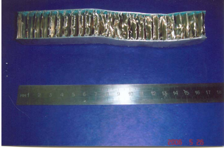
Şekil 7.4 Kesme kıvrımı hatası sonucu oluşan hatalı yapı
