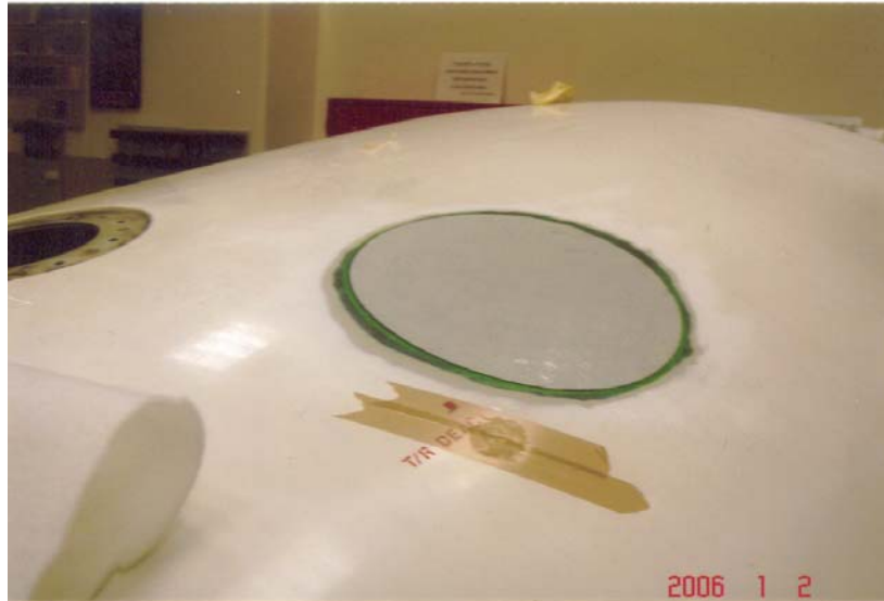
Şekil 3.25 Balpeteği kompozit yapı tamirlerinde karbon tabakalar arasında kullanılan kuru tabaka yapıştırıcılar kürleme işlemi uygulandıktan sonra işlev kazanırlar
