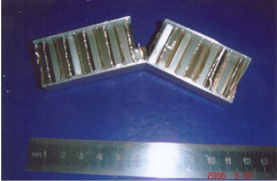
Şekil 7.1 Dayanç hatası sonucu meydana gelmiş kopma görüntüsü
