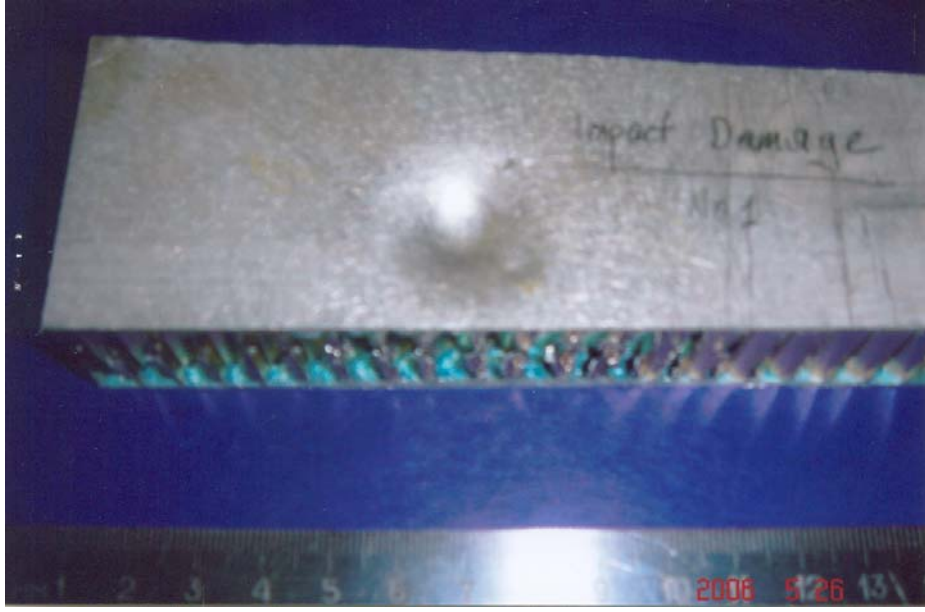
Şekil 7.8 Bölgesel basınç (impact damage) sonucu oluşan hasarlı bölgenin üstten görünümü
