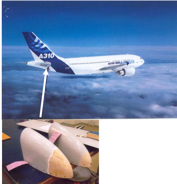
Şekil 4.8 Airbus 310 uçağının yatay stabilizatör (dengeleyici) tamamen prepreg malzemeden üretilmiş olup, tamiri kolay bir yapıdadır
