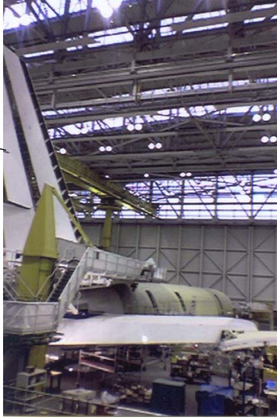
Şekil 7.28 Bir yolcu uçağının imalat aşamasında dikey kumandasının görünümü (Airbus, 2003)
