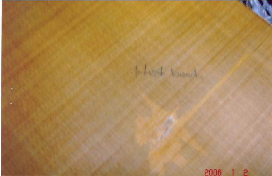
Şekil 7.36 Hasarlanmış kompozit sandviç yapının gözle muayenesi
