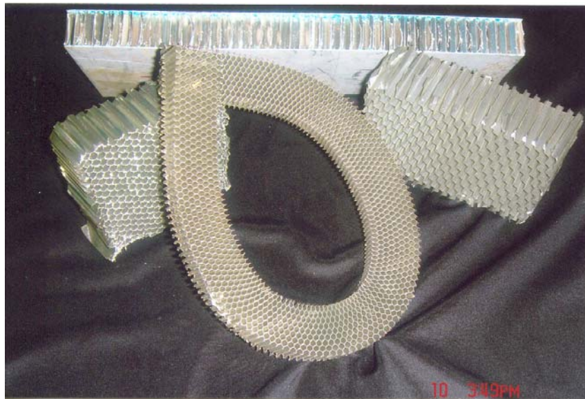
Şekil 3.2 Tamamen alüminyum petek ve alüminyum yüzey tabakalardan üretilmiş sandviç yapı örnekleri
