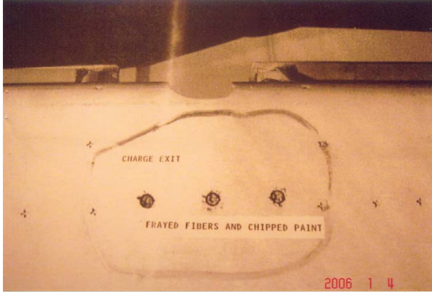
Şekil 5.2 Bozulmuş fiberler ve boya bozuklukları (Boeing 4 , 1996)
