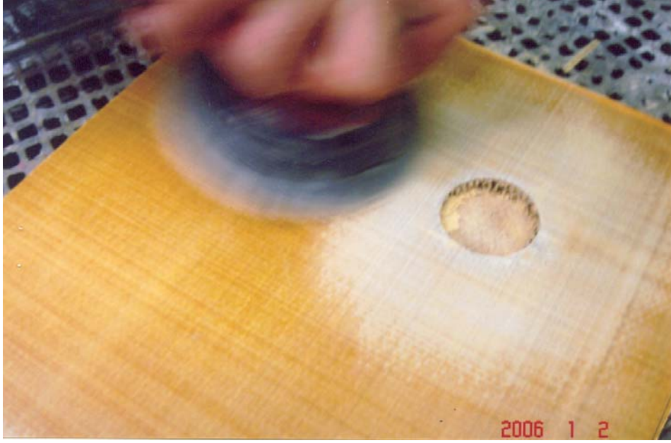
Şekil 7.61 Yüzey tabakası zımpara makinasıyla düzeltilmiştir. Zımparalama sonucu yüzey seviyesi düzgünlüğünün limitler dahilinde olduğu gözlenmiştir. Bölgedeki boya ve diğer kalıntılar temizlenmiş, bölge kurutulmuş ve temizlenmiştir
