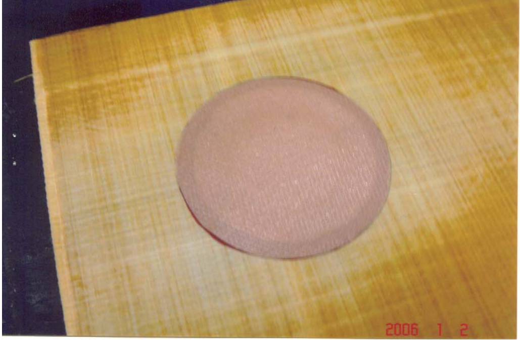
Şekil 7.83 Tamir malzemesi vakumdan çıkarıldı, temizlendi, tabaka aralıkları kontrol edildi. Tabaka aralıkları belirlendi. Tamir katları yayıldı
