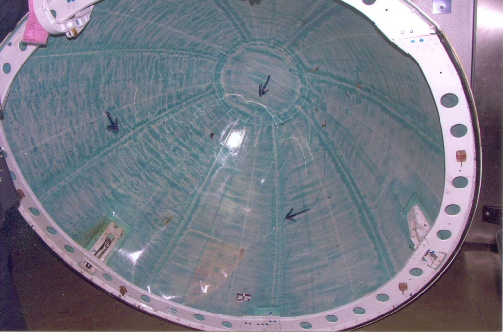
Şekil 7.106 Airbus 320 radomunun iç bölgedeki hasarının görünümü
