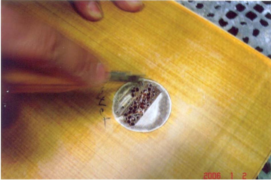
Şekil 7.58 Petek hücrelerinde zarar gördüğü gözlenmiştir
