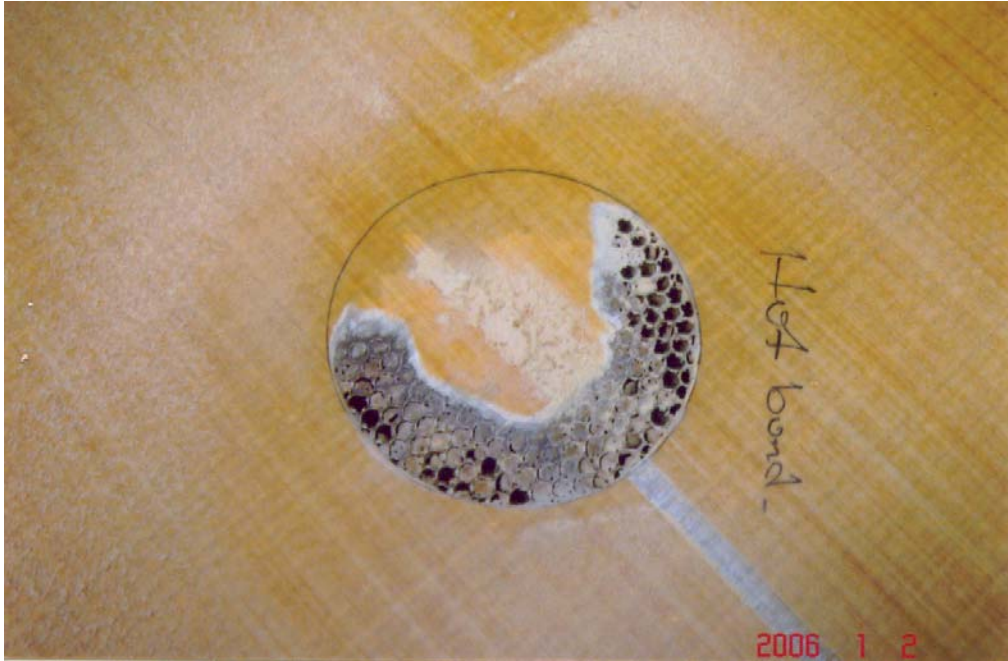
Şekil 7.74 Hasarlı bölge diđer bölgelere zarar vermeden çıkarıldı. Hasarsız alt tabaka yapı bırakıldı
