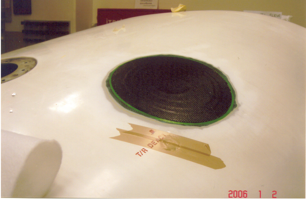
Şekil 7.92 Oryantasyon gereklerine azami ölçüde riayet edilerek tatbik edilen son karbon katından sonra parça temizlenmiş ve kontrol edilmiştir
