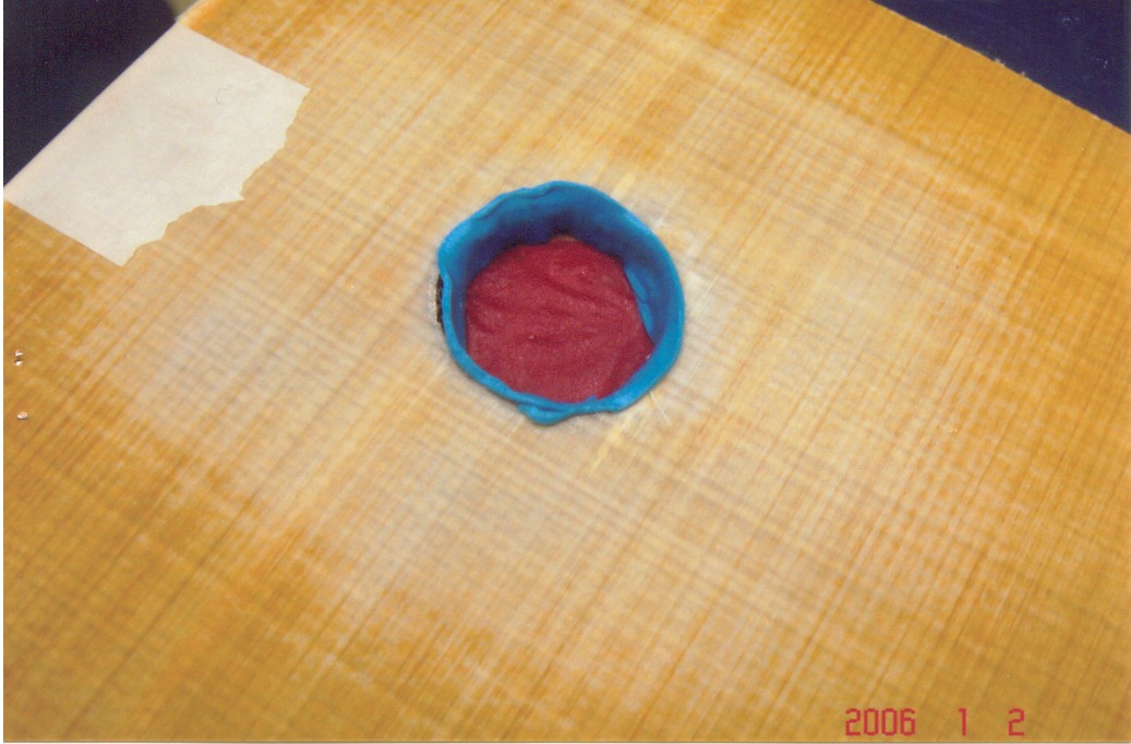
Şekil 7.78 Köpük yapıştırıcı kenarlara yerleştirildi. Yapıştırıcının yerleştirilecek hücreden büyük olmasına dikkat edildi
