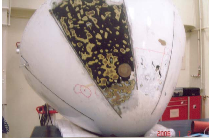
Şekil 5.18 Tamir edilmiş Boeing 737-400 uçağının radom bölümünün dışı alüminyum tabaka, içi ise balpeteğinden (prepreg) meydana gelmektedir. Eddy akımları muayene yöntemiyle bu bölgenin kalınlığını ölçmek mümkündür.
