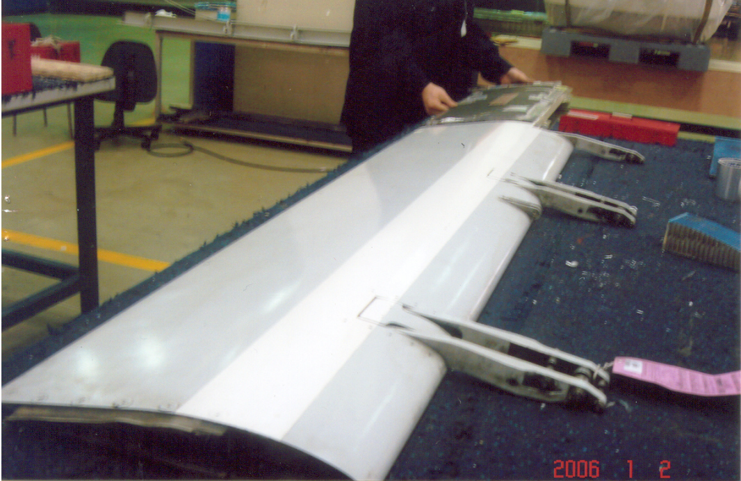
Şekil 7.102 Parçanın üzerine alüminyum tabaka yerleştirilmiş, yapıştırıcı tatbik edilmiş vakum altında kür edilerek gerekli testleri yapılmış, boyandıktan sonra servise verilmiştir
