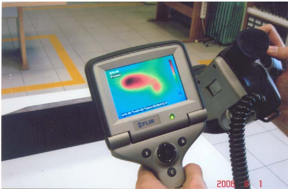
Şekil 7.52 Flir Thermacam P-10 cihazıyla muayenenin uygulaması görüntüsü
