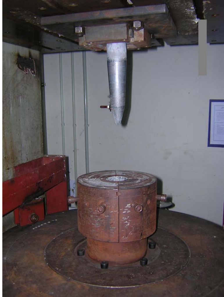
Şekil 4.3 Sıvama döküm kalıpları
