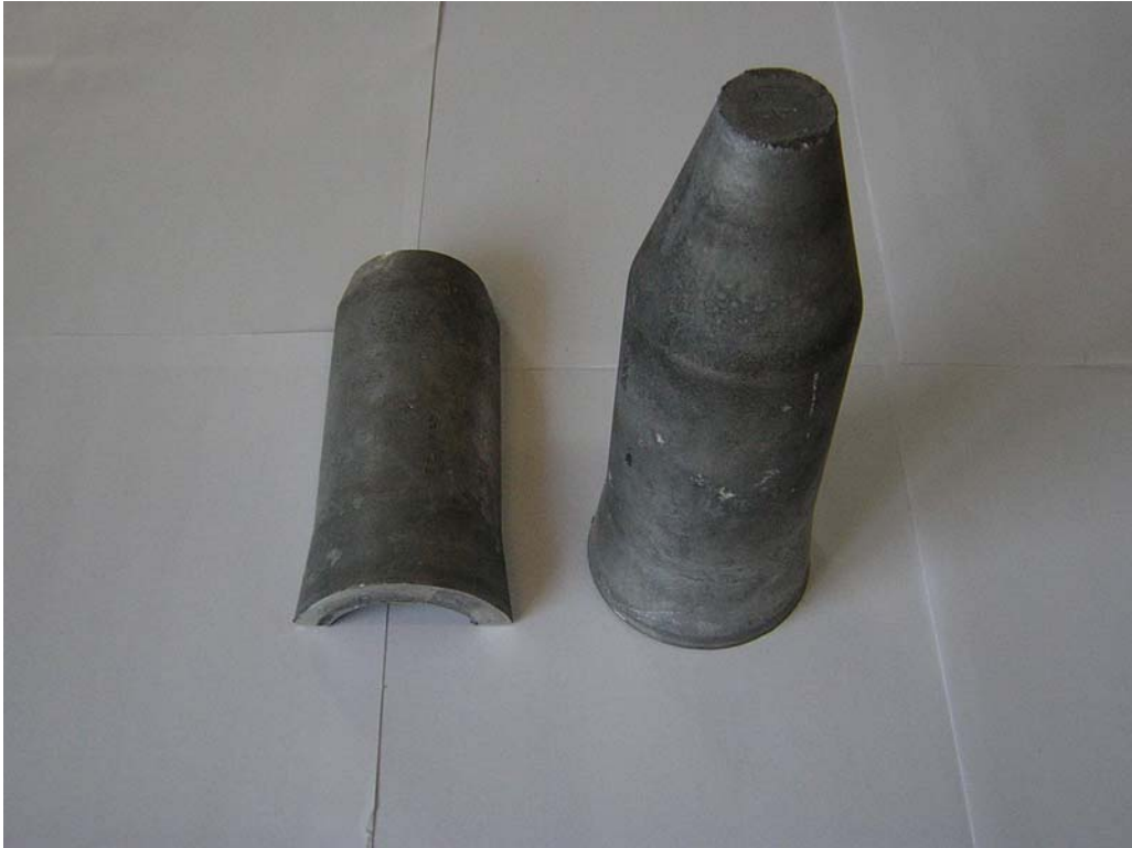
Şekil 4.9 Sıvama dökümle üretilmiş döküm parçaları
