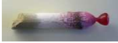
Şekil 1.7. \text{Cr}_2\text{O}_3 ilaveli safir başlangıç kristali (en.wikipedia.org)
