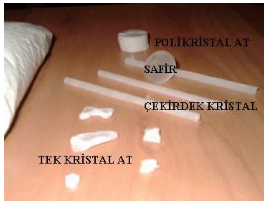
Şekil 6.3 Büyütülen AT kristali, polikristal AT, safir ve çekirdek kristaller
