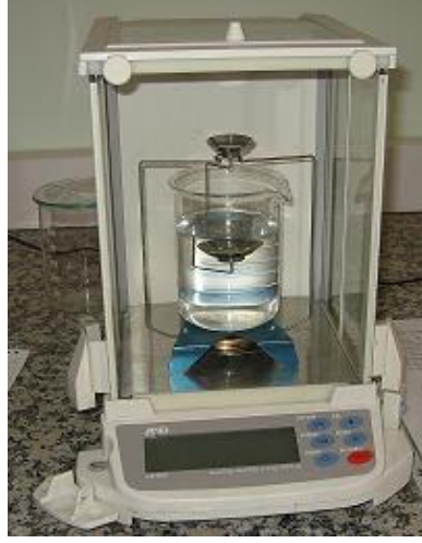
Şekil 6.13. Numunelerin yoğunluk ölçümünde kullanılan yoğunluk ölçüm cihazı
