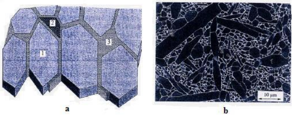
Şekil 5.8. a) Sıvı faz sinterlenmiş \text{Si}_3\text{N}_4 seramiğinin mikroyapısı 1- \text{Si}_3\text{N}_4 matriks taneleri, 2- kristalin ikincil faz, 3) üçlü bağlantılardaki ve tane sınırlarındaki amorf atık b) SEM mikroyapısı (Matovic,2003; Bernal-Bocenagra vd.,2009)
