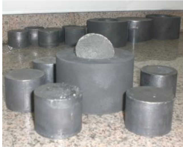
Şekil 6.11. Toz karışımlarının konduğu 50 mm çapındaki SPS grafit kalıbı
