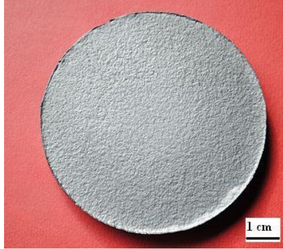
Şekil 6.49. 1650 °C'de 40 MPa basınçta 5 dakika süreyle Si 3 N 4 matriks içine SiC doğrudan katılarak sinterlenen numune
