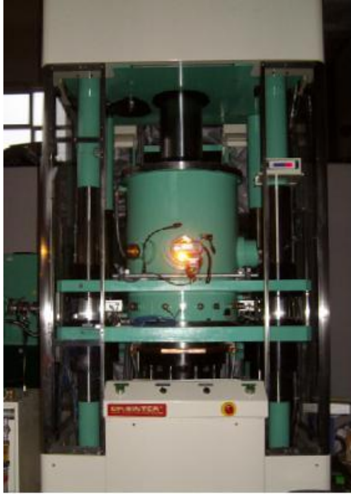
Şekil 6.12. Sinterlemede kullanılan DR. Sinter marka 7.40MK-V model SPS Cihazı
