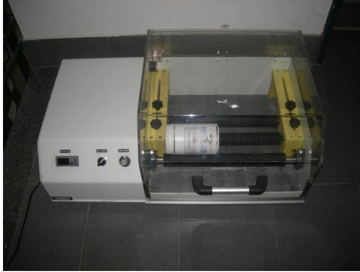
Şekil 6.10. Deneylerde kullanılan tozların karıştırılmasında kullanılan bilyalı değirmen
