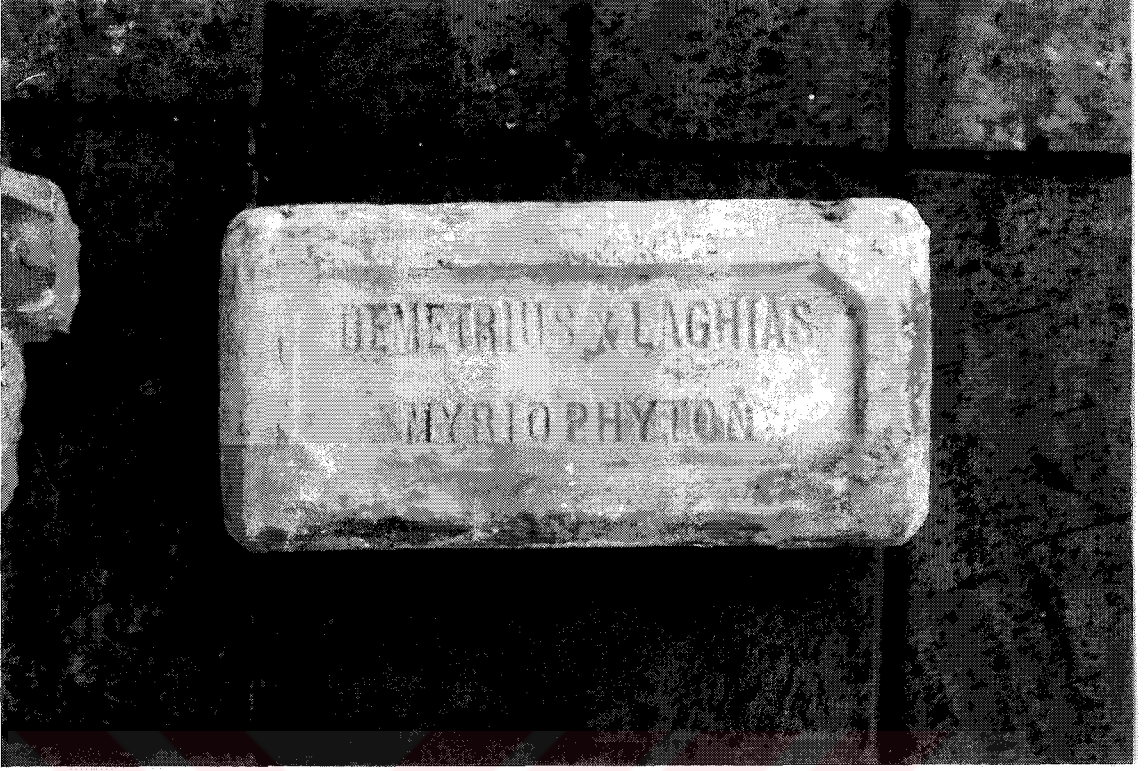
Resim 3.115 Akaretler'de kullanılan modern ölçülü tuğla ( 22 x 10.5 x 6.5 cm.) (ön yüz)
