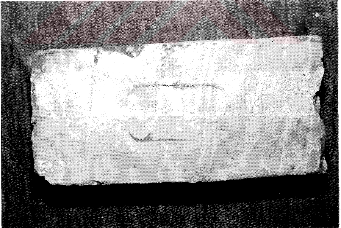
Resim 3.106 Akaretler'de kullanılan modern ölçülü tuğla ( 21.5 x 10.5 x 7 cm.)
