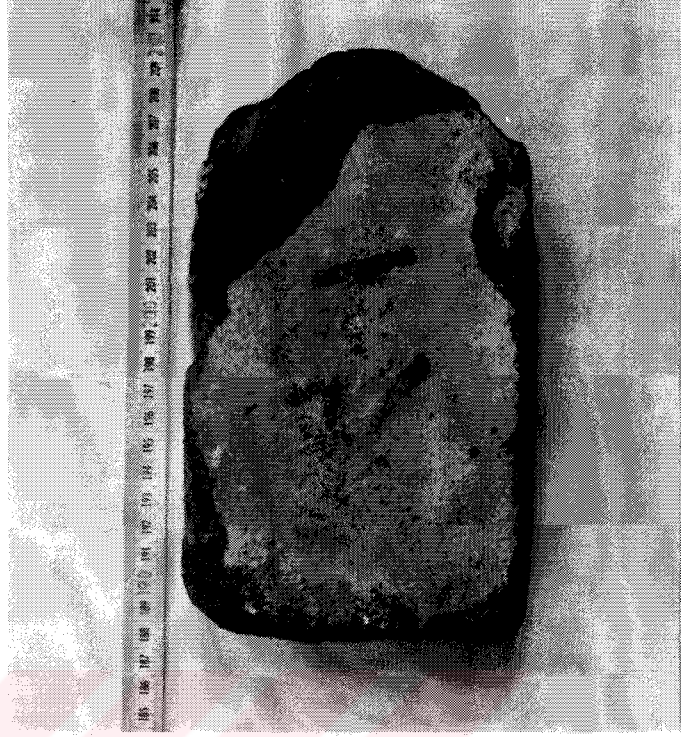
Resim 3.59 Fer' iye Sarayları, Müştemilat Binası, taşıyıcı duvar tuğlası (23x11.5x5.5 cm.)
