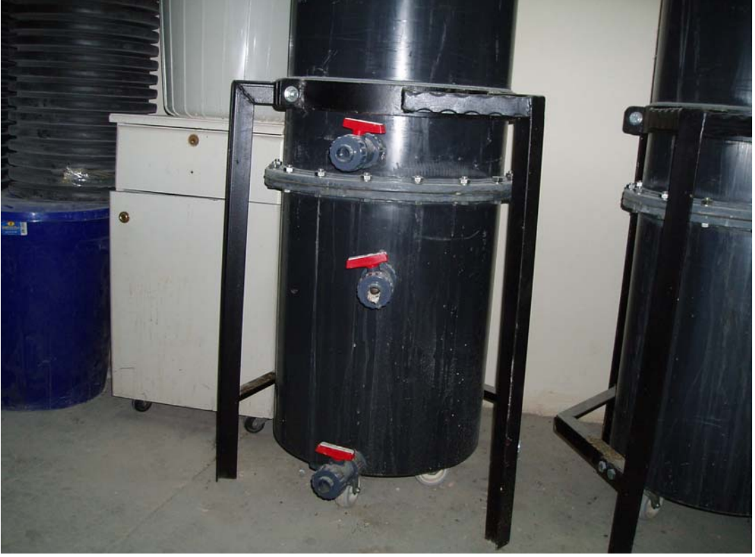
Şekil 4.4 Sızıntı suyu ve yer altı suyunu temsil eden saf su numune alma muslukları
