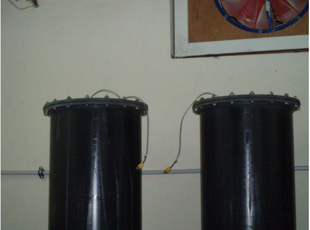
Şekil 4.5 Reaktörün içine yerleştirilen sıcaklık probu
