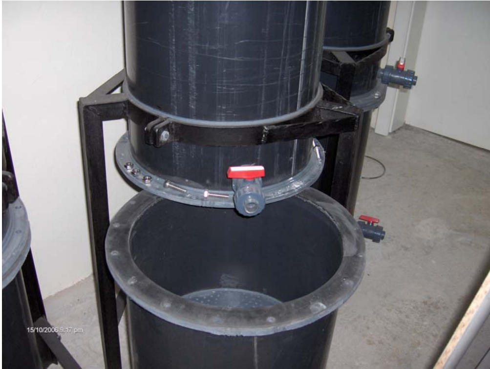
Şekil 4.3 Numune alma musluğu ve reaktörlerin alt bölümü
