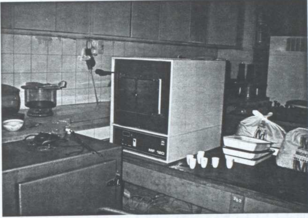
Şekil E.3 1200 °C'lık elektrikli kül fırını
