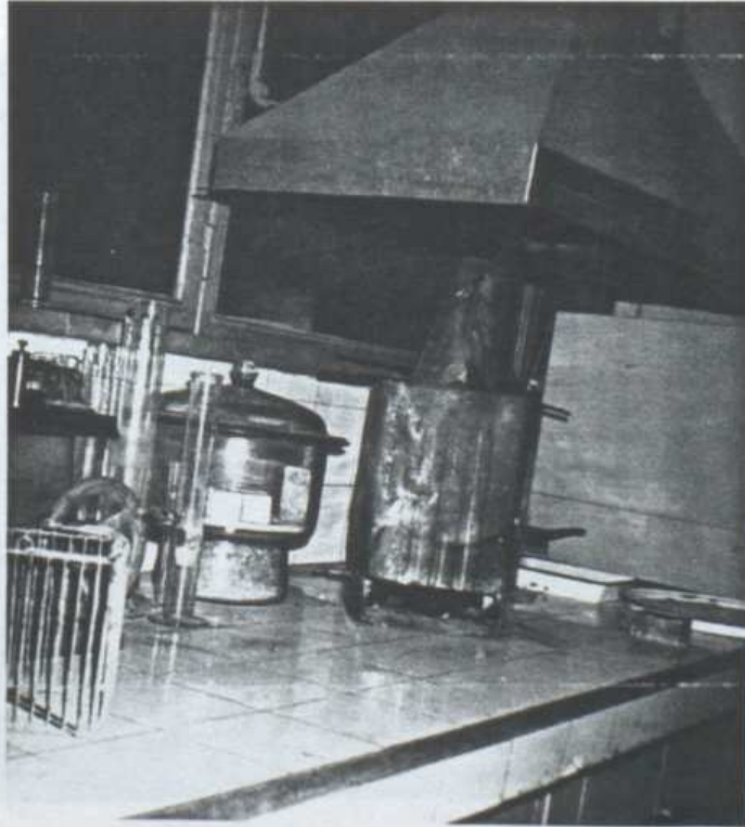
Şekil E.2 Buğday sapını yakmada kullanılan bacalı kova
