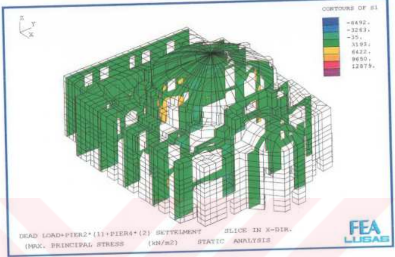
Şekil 9.117. Yapının Kendi Ağırlığı Altında 2. ve 4. Ayağın Farklı Oranda Çökmesi (Max. Gerilme Diyagramı)
