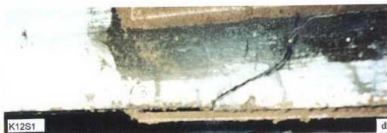
Resim 2. a K12REF kirişinin kırılma yükünde çatlak modeli b-c-d K12S1 güçlendirilmiş kirişinin kırılma yükünde çatlak modeli ve detayı
