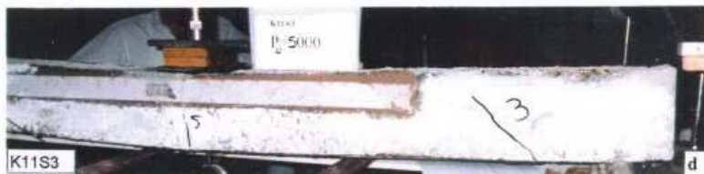
Resim 1. a-b K11REF kirişinin kırılma yükünde çatlak modeli ve detayı c-d K11S3 güçlendirilmiş kirişinin kırılma yükünde çatlak modeli ve detayı
