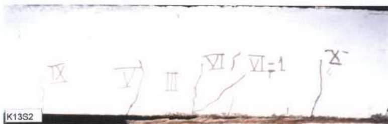
Resim 3. a-b K13REF kirişinin kırılma yükünde çatlak modeli ve detayı c-d K13S2 güçlendirilmiş kirişinin kırılma yükünde çatlak modeli ve detayı
