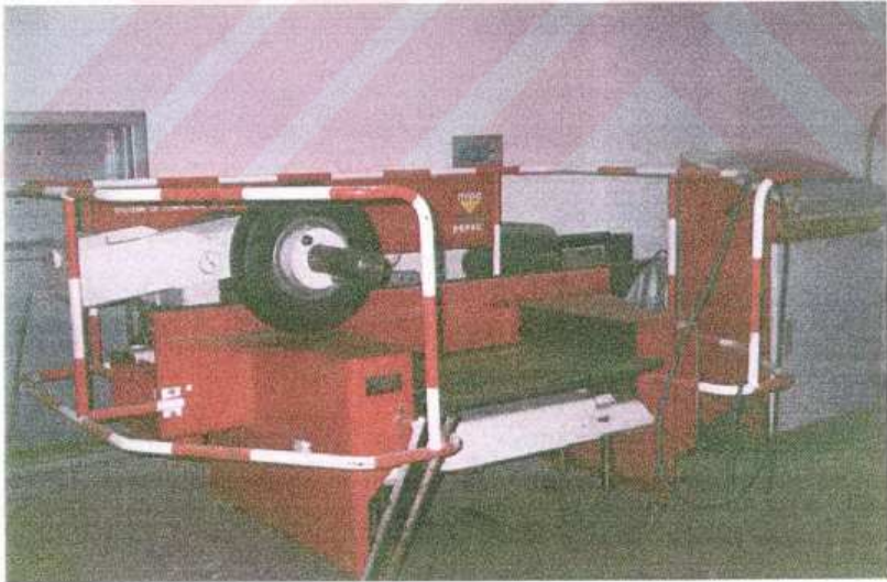
Şekil 7.25 LCPC tekerlek izi deneyi için kullanılan sıkıştırma ekipmanı
