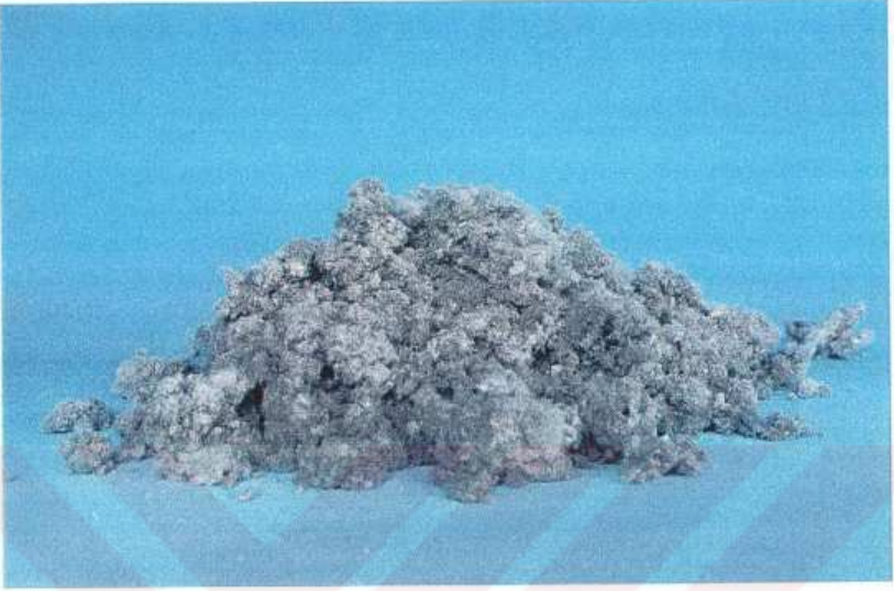
Şekil 6.3 Selülozik Elyaf (SE) katkı malzemesi
