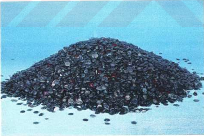
Şekil 6.5 Poliolefin (PE) katkı malzemesi
