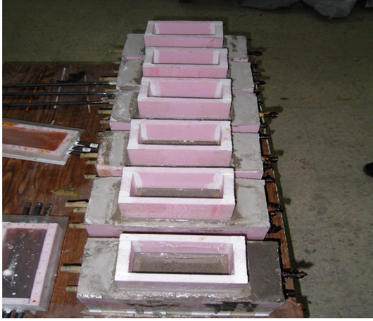
(a) Betonarme Numunelerin Genel Görünüşü
