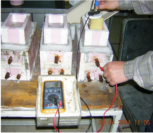
(c) Betonarme Numunelerde Yarı Hücre Potansiyeli Ölçümü
