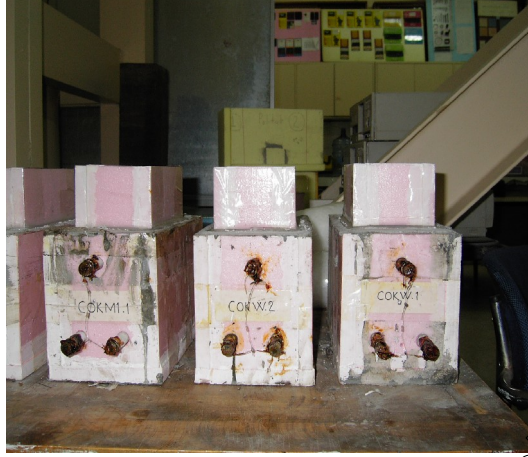
(b) Betonarme Numunelerin Detay Görüntüsü
