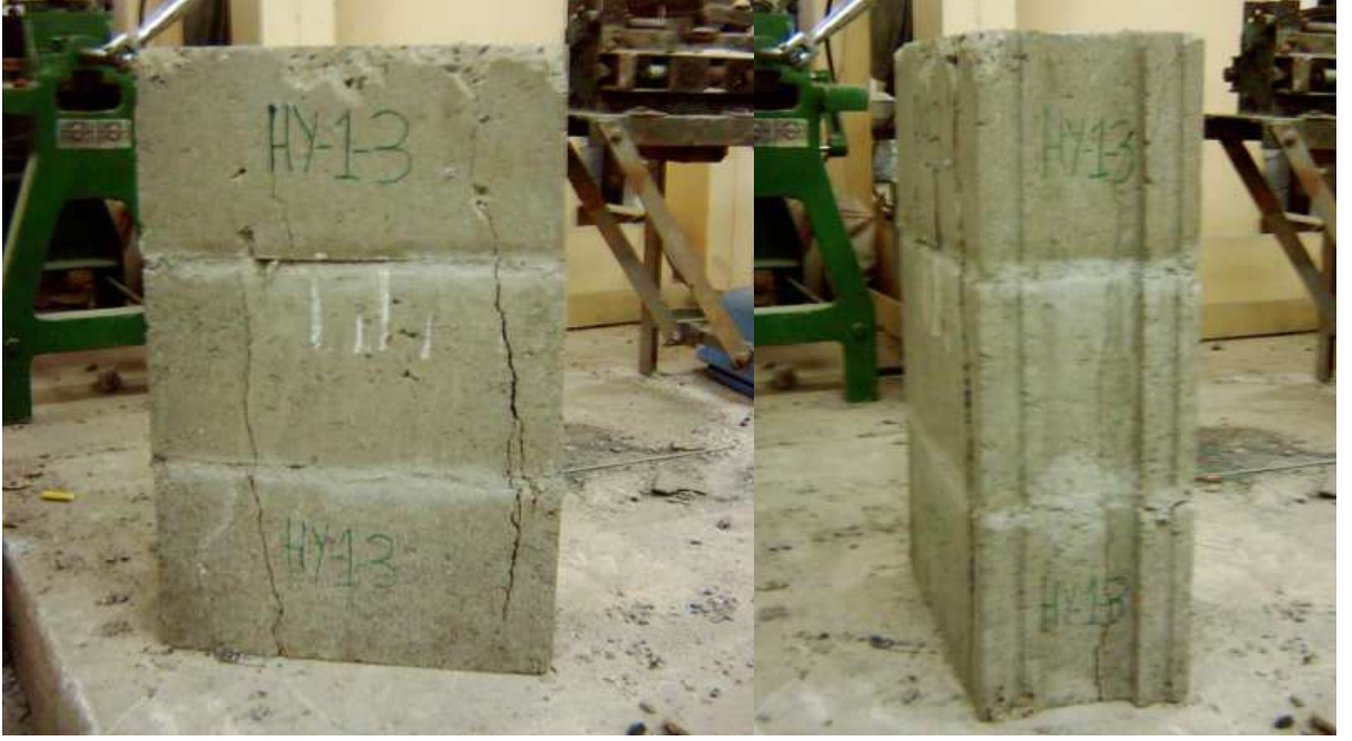
Şekil 7.29 İçi dolu prizmaların dış kabuklarında meydana gelen düşey çatlaklar.
