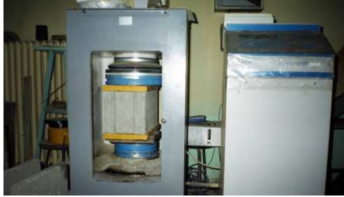
Şekil 7.20 Beton blokların basınç dayanımının belirlenmesi.
