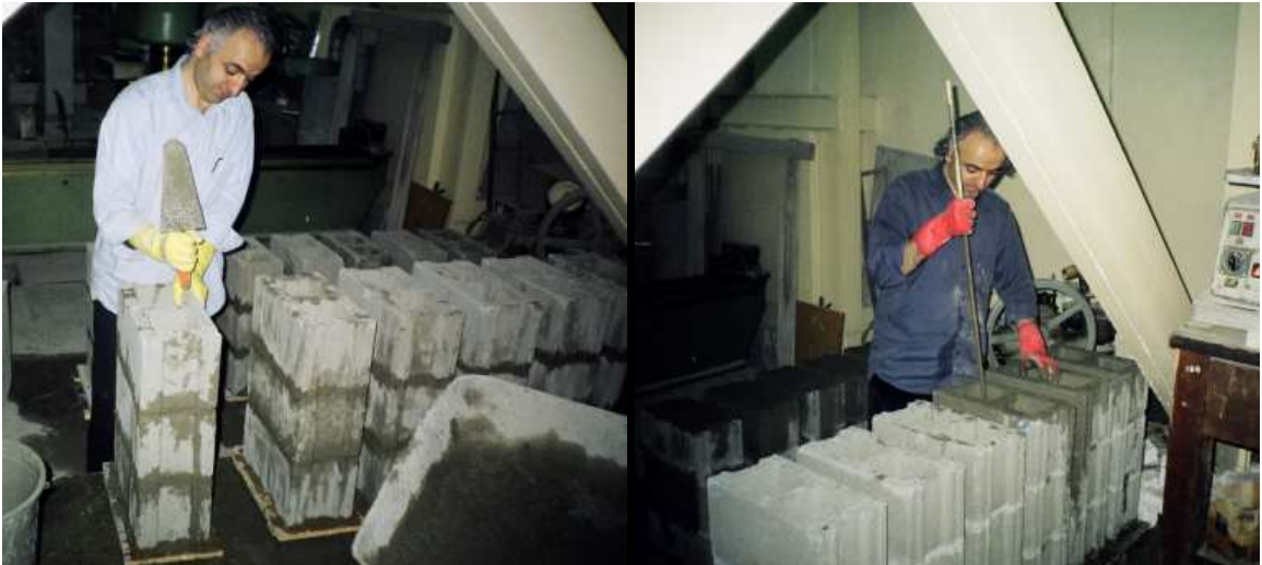
Şekil 7.23 İçi boş ve dolu prizmaların hazırlanması.
