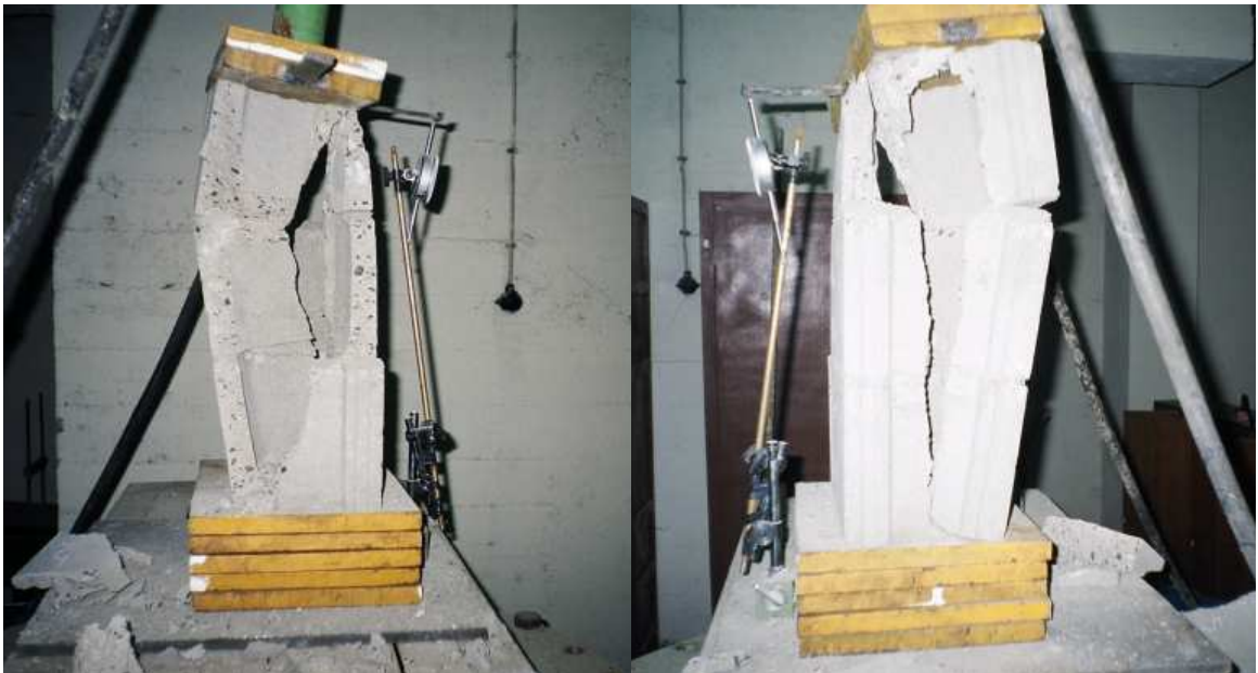
Şekil 7.6 Denenen içi boş prizmanın kırılma yükünden sonraki durumu.
