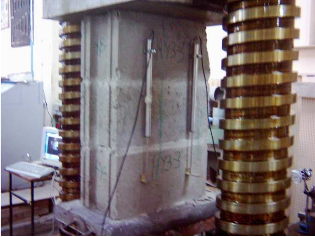
Şekil 7.28 LVDT bağlanmış numune.
