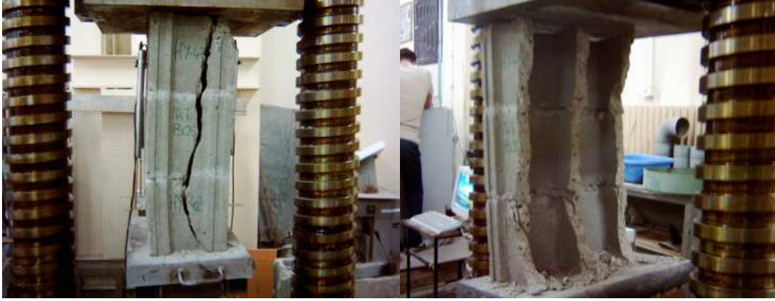
Şekil 7.33 Orta kabuklarında boyuna oluşan çatlakların birleşmesi sonucu kırılmış içi boş prizma.
