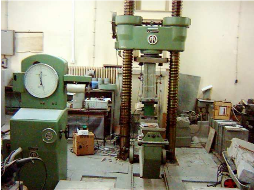
Şekil 7.27 5000 kN luk basınç aleti ve deney düzeneği.
