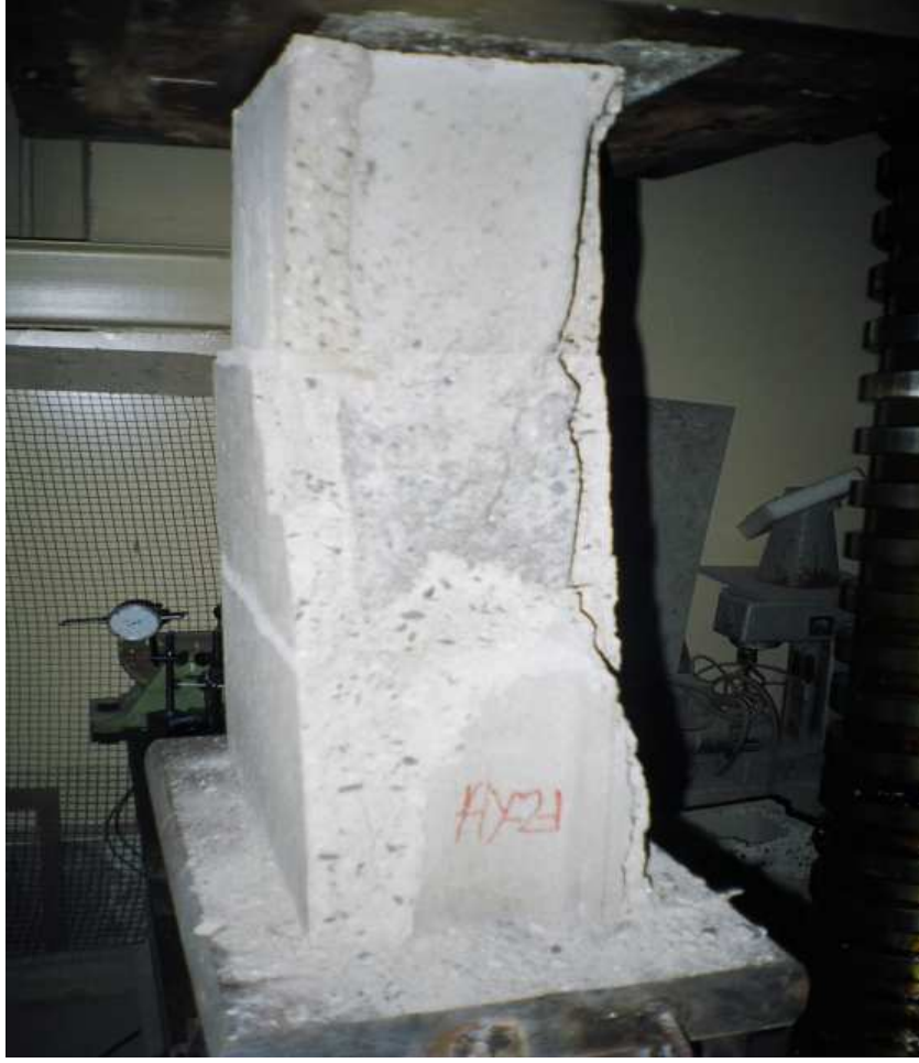
Şekil 7.31 Kırılmış içi dolu prizma.
