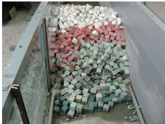
Şekil 8.32 Tam hasara ulaşmış topuklu küp dalgakıran (3 mm 5 Hz için hasarlı dalgakıran modeli)
