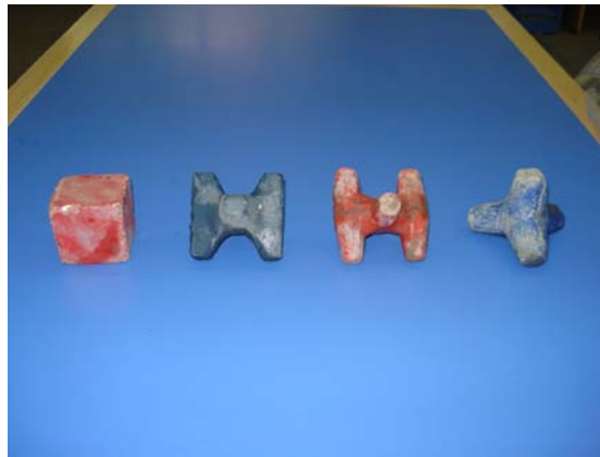
Şekil 4.16 Tabakalı dalgakıran modellerinde kullanılan yapay bloklar
