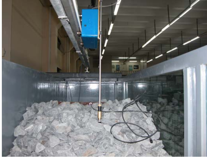
Şekil 4.4 Profil kaydedicinin çalışma esnasındaki bir görüntü
