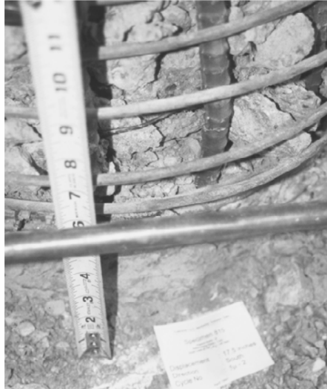
Mesnet kesiti (bükülmüş boyuna donatının kırılması)
