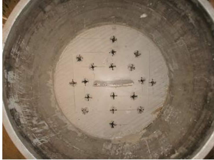
Şekil 5.5 PDD'den yatay ve düşey doğrultuda değişik uzaklıklarda drenajsız kayma dayanımının belirlendiği noktalar
