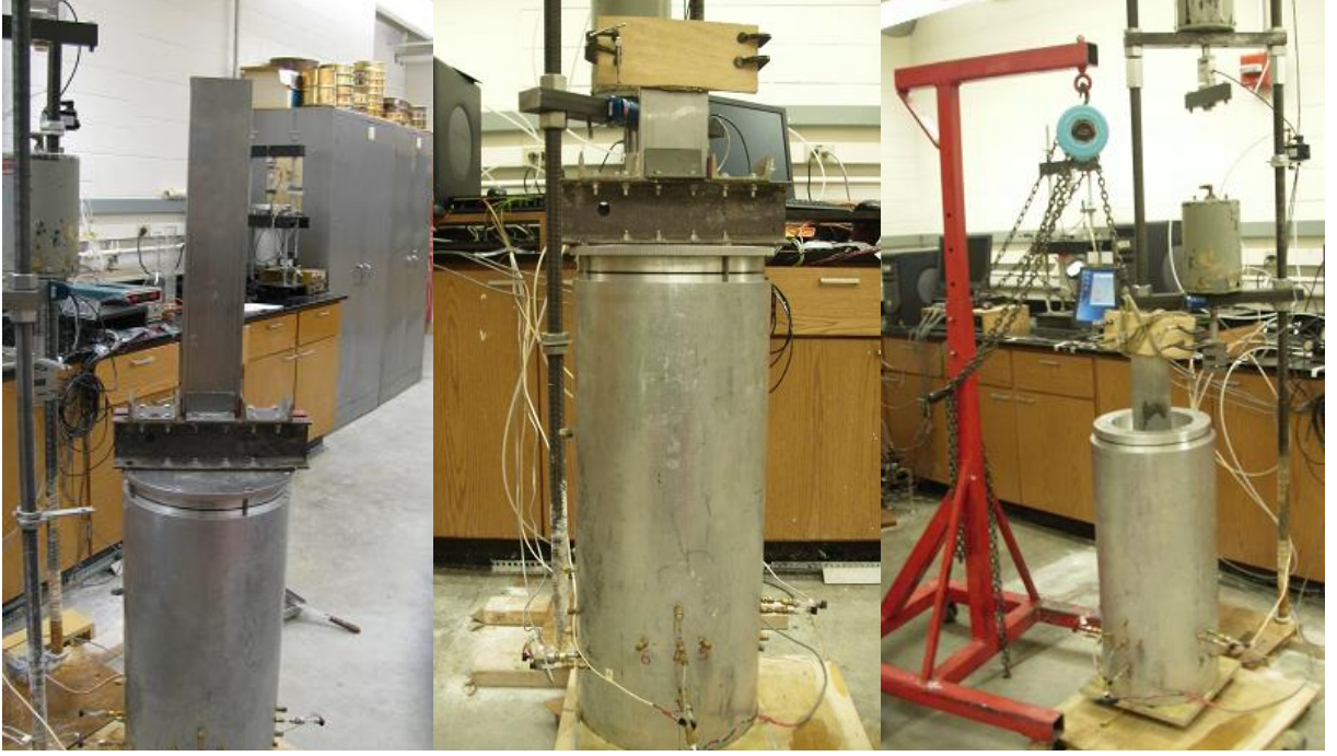
Şekil 6.2 Arazi model deneyinde PDD'nin zemine yerleştirilmesi yöntemi
