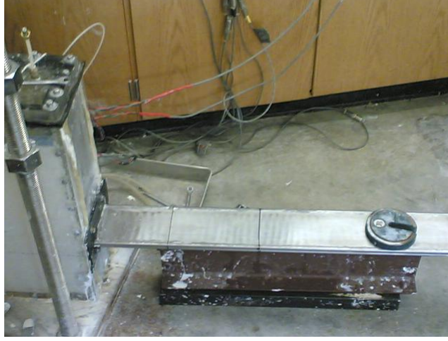
Şekil 4.4 Örselenme bölgesi model deney sisteminde PDD'nin sabit hızla zemine yerleştirilmesi yöntemi
