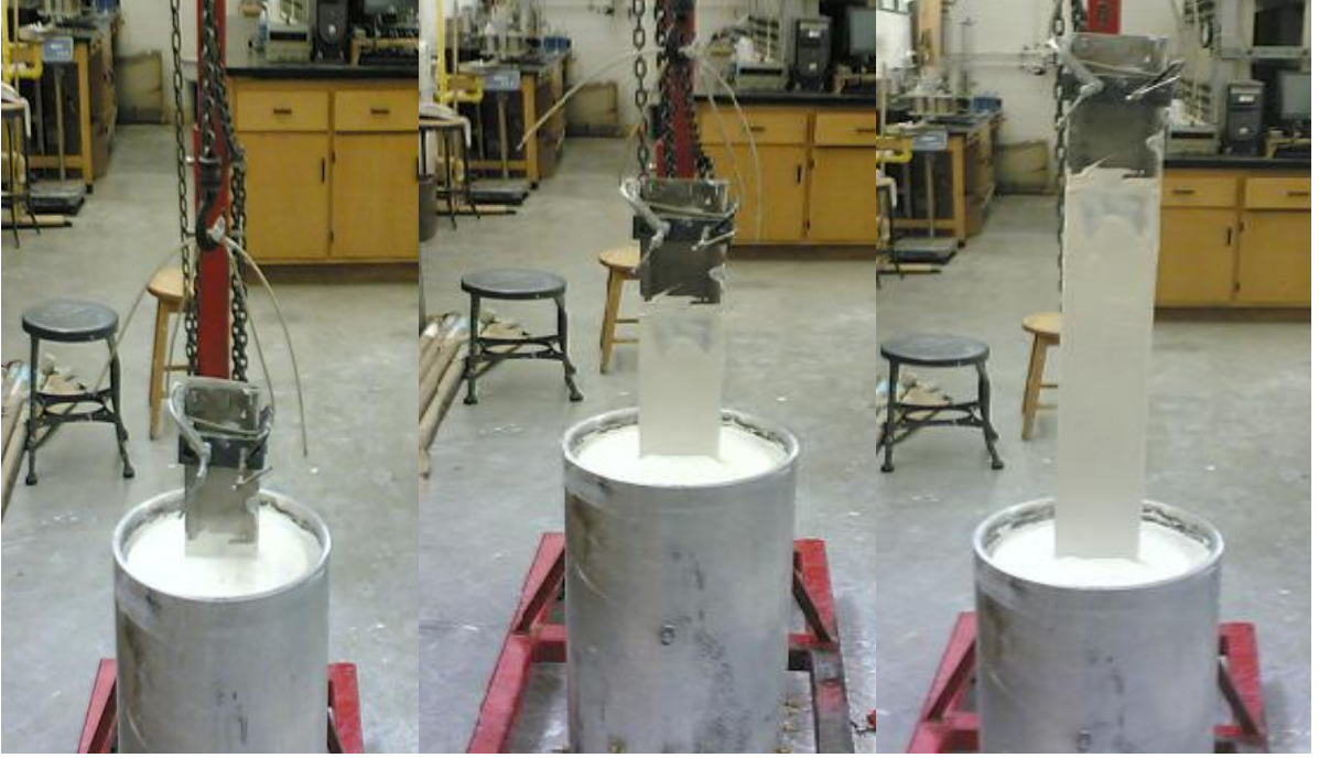
Şekil 5.4 Silindirik büyük boyutlu model deneyde PDD'nin zemine yerleştirilmesi yöntemi
