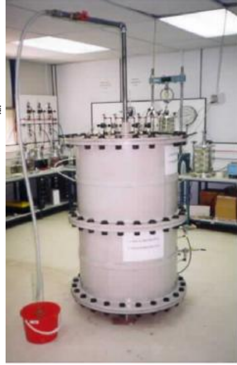
Şekil 2.5 Büyük boyutlu konsolidasyon tankı (ölçekler mm'dir) (Chu vd., 2006)
