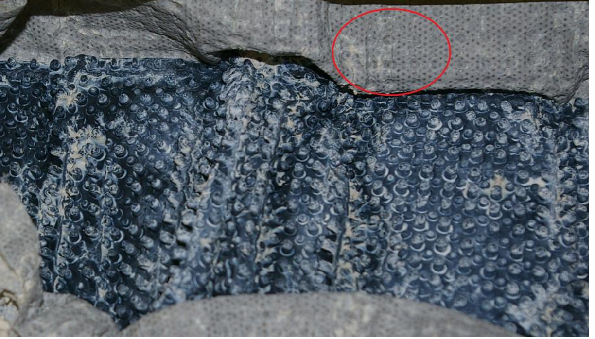
Şekil 5.13 Alidrain’de yanıl gerilme etkisiyle çekirdek bölgesindeki çivilerin etrafını saran geotekstil filtre malzemesinde oluşan zımbalama etkisi
