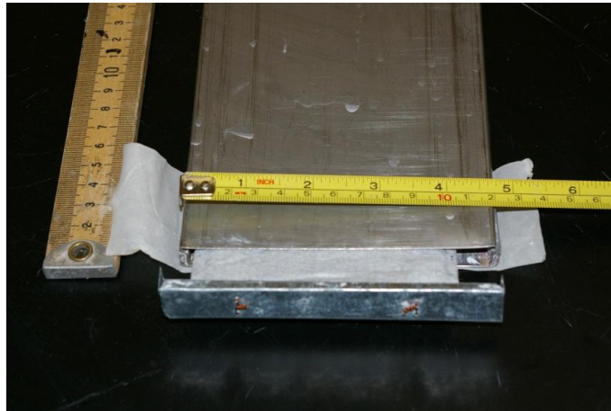
Şekil 4.3 Örselenme bölgesi model deney sisteminde PDD'nin zemine yerleştirilmesinde kullanılan mandrel
