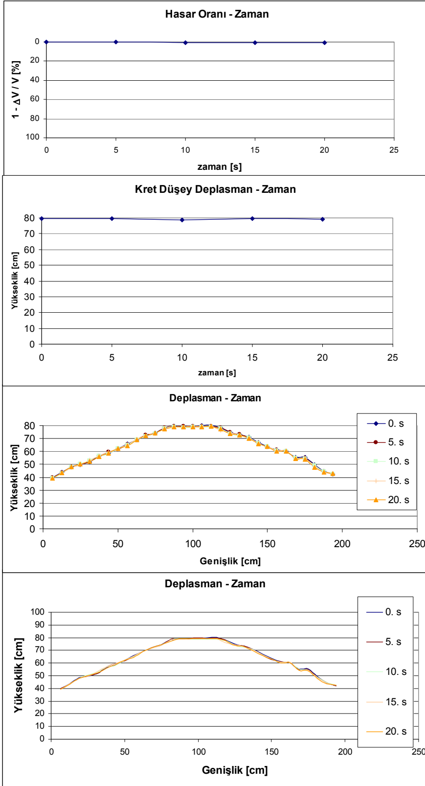
Şekil 5.100 Dalgakıran kesitinde zamana bağlı oluşan deplasmanlar (deney-4)
