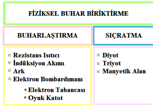
Şekil 2.7 PVD Yöntemlerinin Buharın Oluşturulma Şekline Göre Sınıflandırılması
