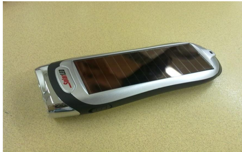
Şekil 5.1 Organik fotovoltaik hücre (şarjlı fener olarak kullanılmakta)
