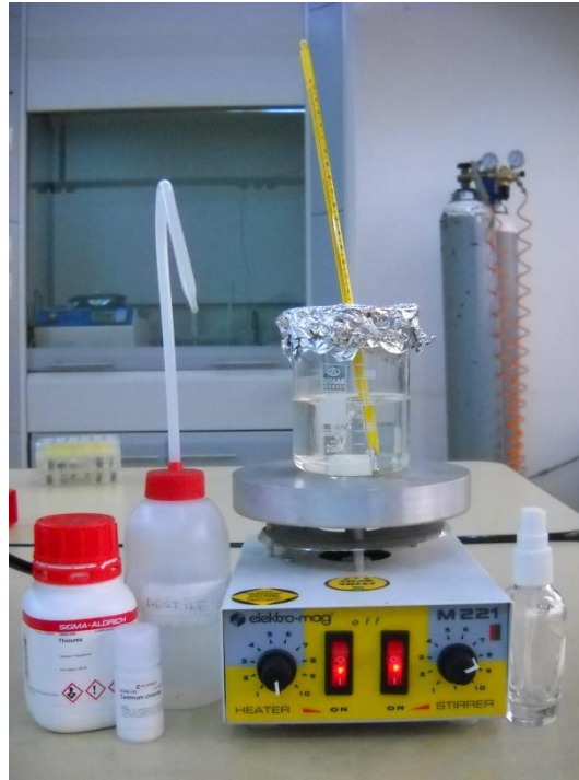
Şekil 6.4 En soldan başlayarak sırasıyla; (\text{NH}_2)_2\text{CS} , \text{CdCl}_2 , destile su, üzerinde CdS çözeltisi karışan manyetik karıştırıcı ve spray şişesi
