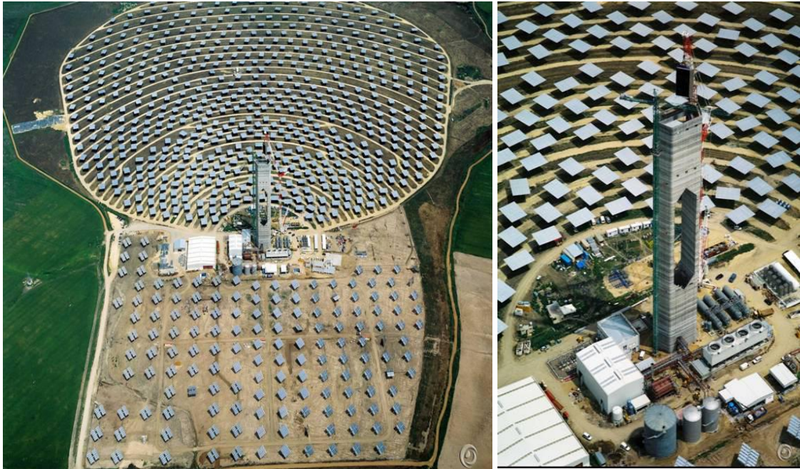
Şekil 3.11 Merkezi alıcı kolektörler
