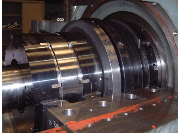
Şekil 3.7 Şaft hattındaki aksel yataklama
