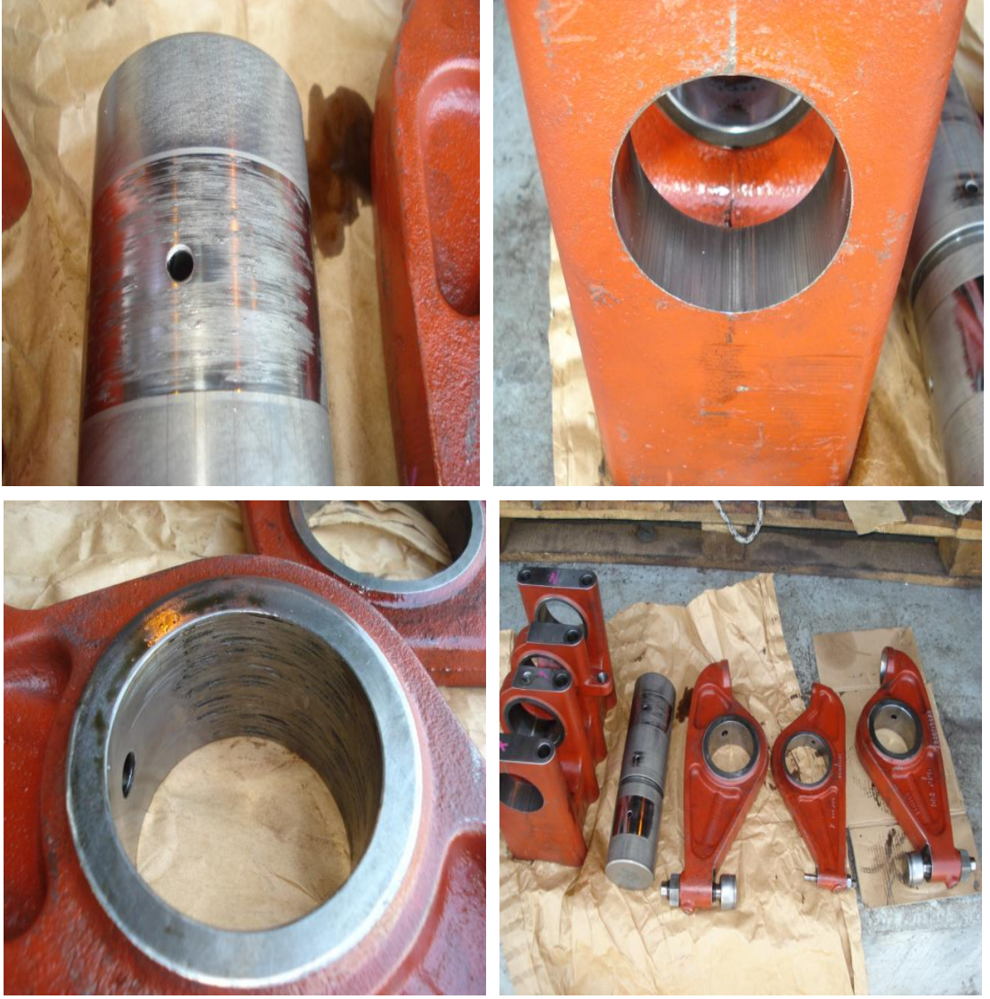
Şekil 6. 53 Roker Armda Gözlemlenen Arıza Örneği
