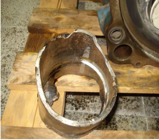
Şekil 6. 68 Gacın Pin (Piston Pimi) ve Gacın Pin Yatağından Resimler
