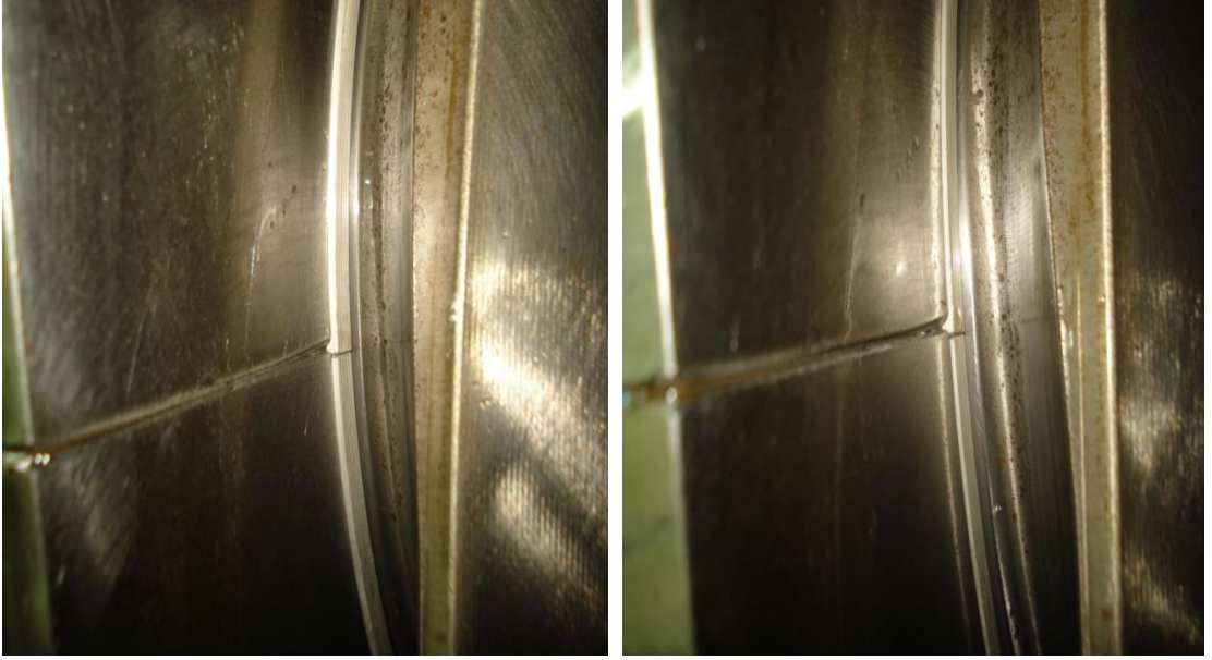
Şekil 6. 52 Dizel Motorlarında Kaymış Yatak Örneği
