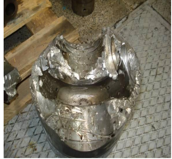
Şekil 6. 67 Pistonlar Biyel Kolundan ve Gacın Pinlerden (Piston Pimleri) Kesilerek Çıkarılması
