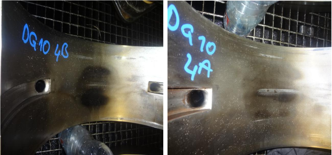
Şekil 6. 57 Yağlama Yağının Eksikliğinden Yataklarda da Görülen Aşınma
