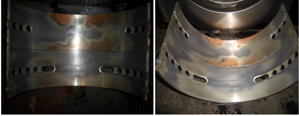
Şekil 6. 50 Dizel Motor Yataklarında Gözlemlenen Arızalar
