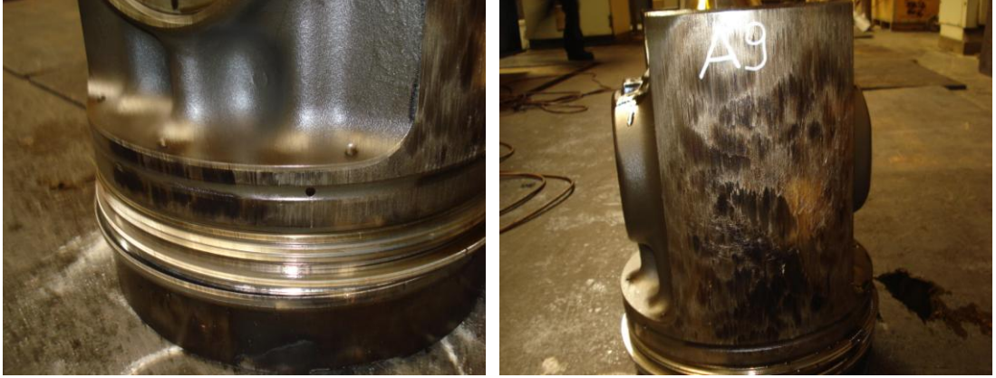
Şekil 6. 72 Çalışma Ömründen Fazla Çalıştırılmış Piston Örneği
