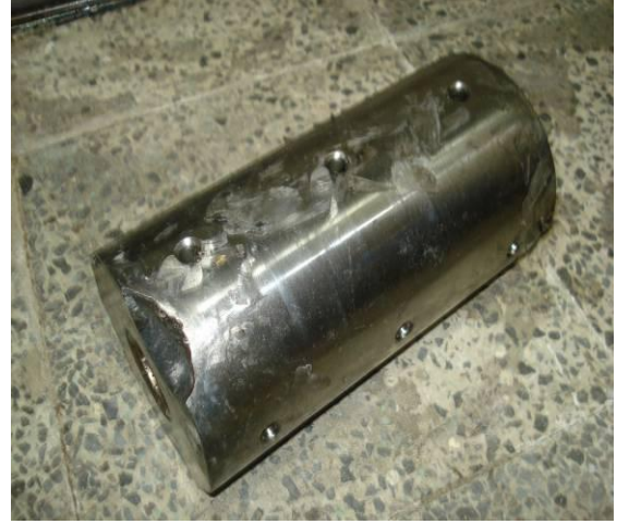
Şekil 6. 68 Gacın Pin (Piston Pimi) ve Gacın Pin Yatağından Resimler
