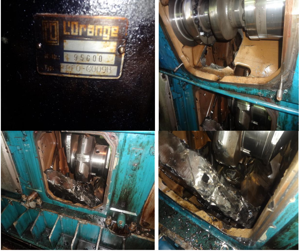
Şekil 6. 54 Konnektin Rodlarda Karşılaşılan Arıza Örneği
