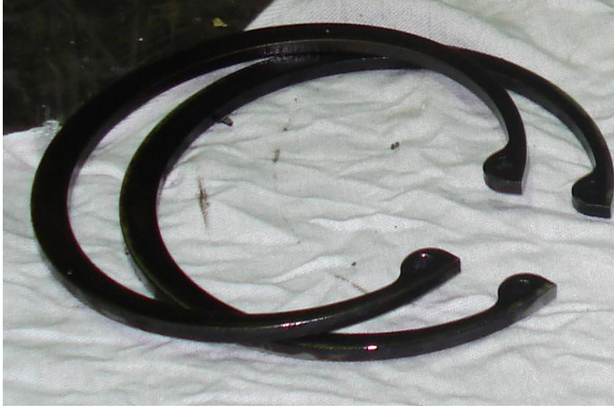
Şekil 3. 10 Dizel Jeneratör Segman Örneği
