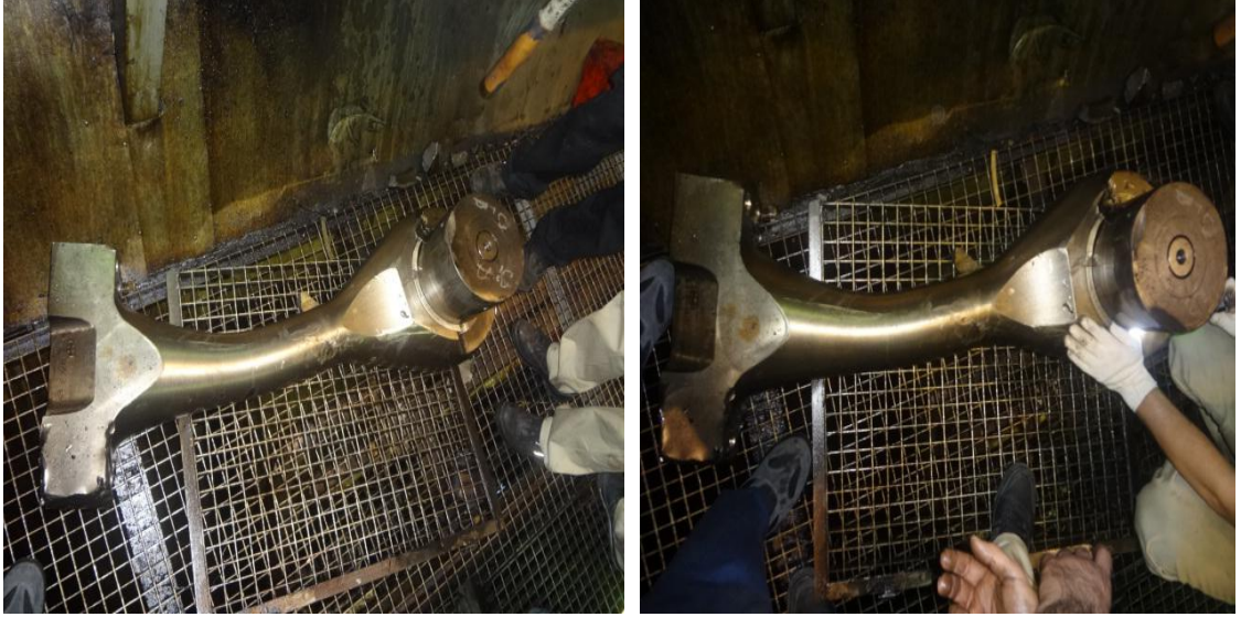
Şekil 6. 56 Yerinden Çıkmayan Gacın Pini ve Biyel Kolu
