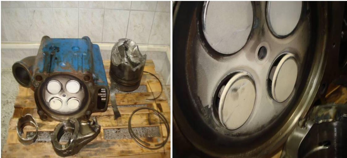
Şekil 6. 66 Arıza Esnasında Piston Kafası Bazı Valflere (Supaplara) Vurarak Eğilmesine Sebep Olmasını Gösteren Resim
