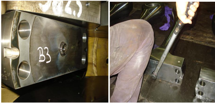
Şekil 6. 55 Biyel Kolu Yağlama Kanalları Ağzında Bulunan Çek Valf Örneği
