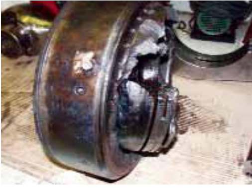
Şekil 6. 77 Piston Taç Kısımında Oluşan Tıkanıklık ile Silindir Laynerinin Üst Bölgesi
