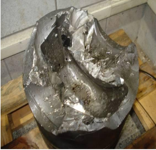
Şekil 6. 67 Pistonlar Biyel Kolundan ve Gacın Pinlerden (Piston Pimleri) Kesilerek Çıkarılması
