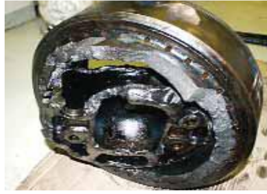
Şekil 6. 77 Piston Taç Kısımında Oluşan Tıkanıklık ile Silindir Laynerinin Üst Bölgesi
