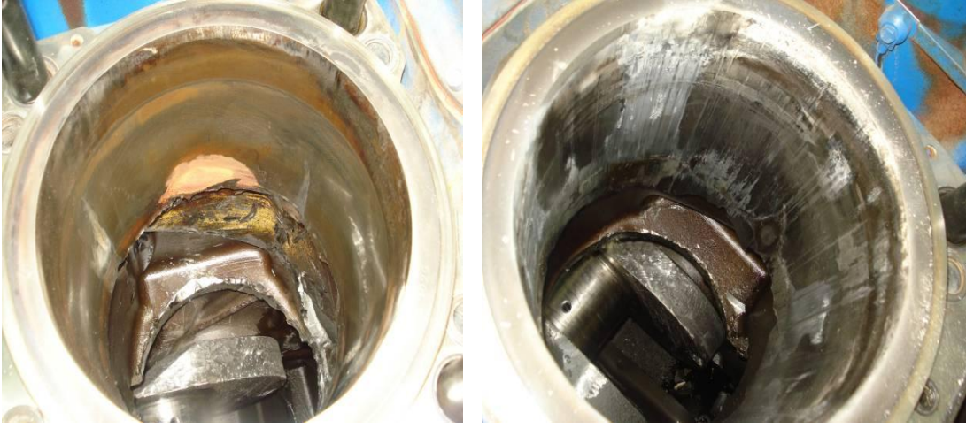
Şekil 6. 64 A2 ve B2 Laynerlerinin Bir Kısmı Blok Üzerinde Kırılmasının Sonucu
