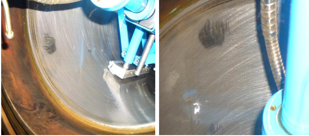
Şekil 6. 73 Çizik Layner Örneği
