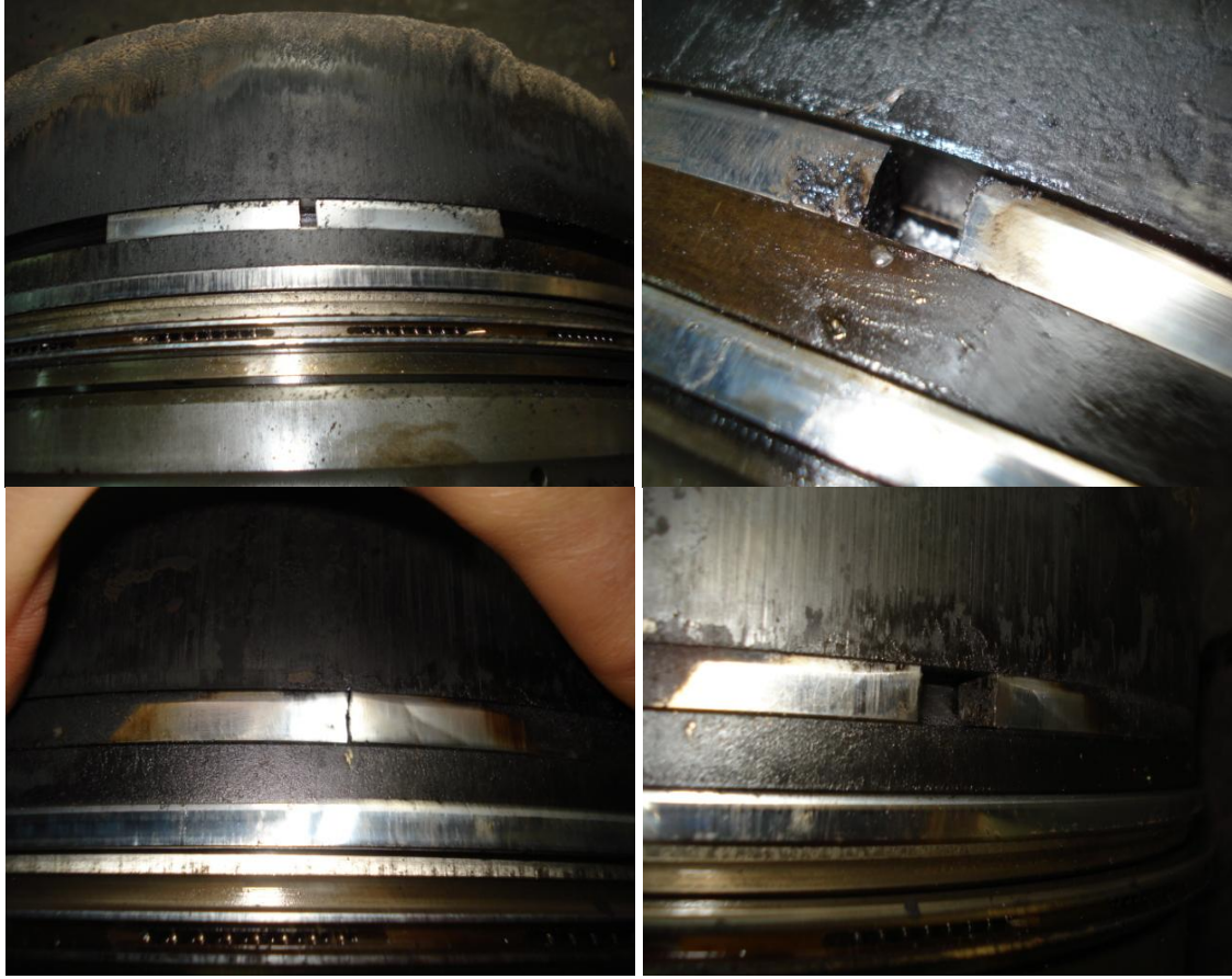
Şekil 6. 49 Segman Kırılmalarına Örnekler
