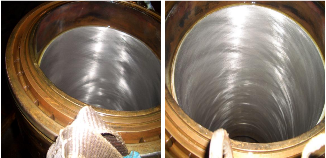
Şekil 6. 75 Honlama Yapılmış Layner Yüzeyi
