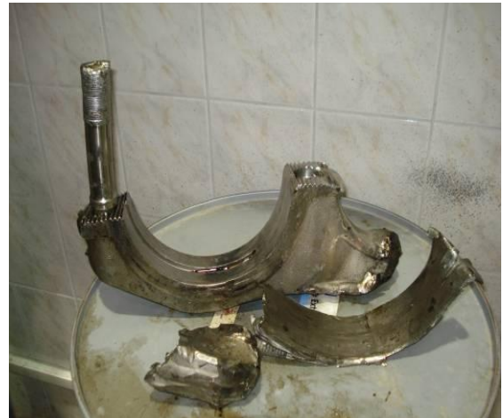
Şekil 6. 69 Çıkarılan Konnektin Rod ( Biyel kolu ) Yataklarından Resimler
