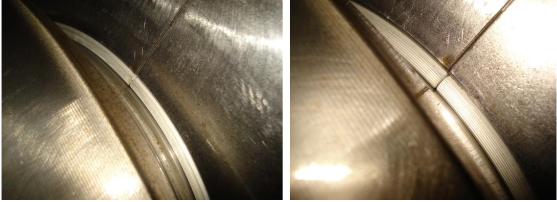
Şekil 6. 51 Dizel Motor Yataklarında Kaymadan Oluşan Arıza
