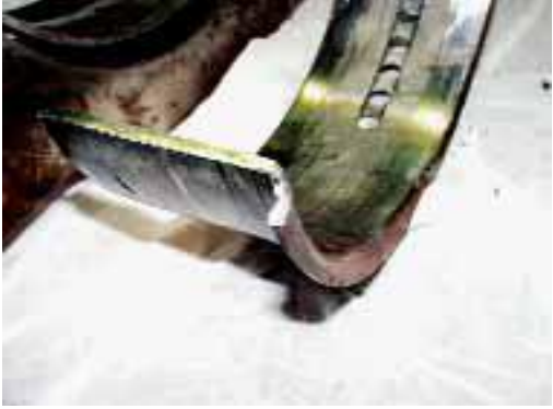
Şekil 6. 78 Yatakta Gözlemlenen Hasara Ait Görüntü
