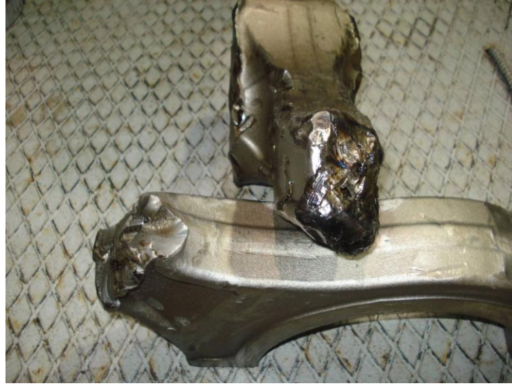
Şekil 6. 59 Kırılan B2 Biyel Kolunun Resmi
