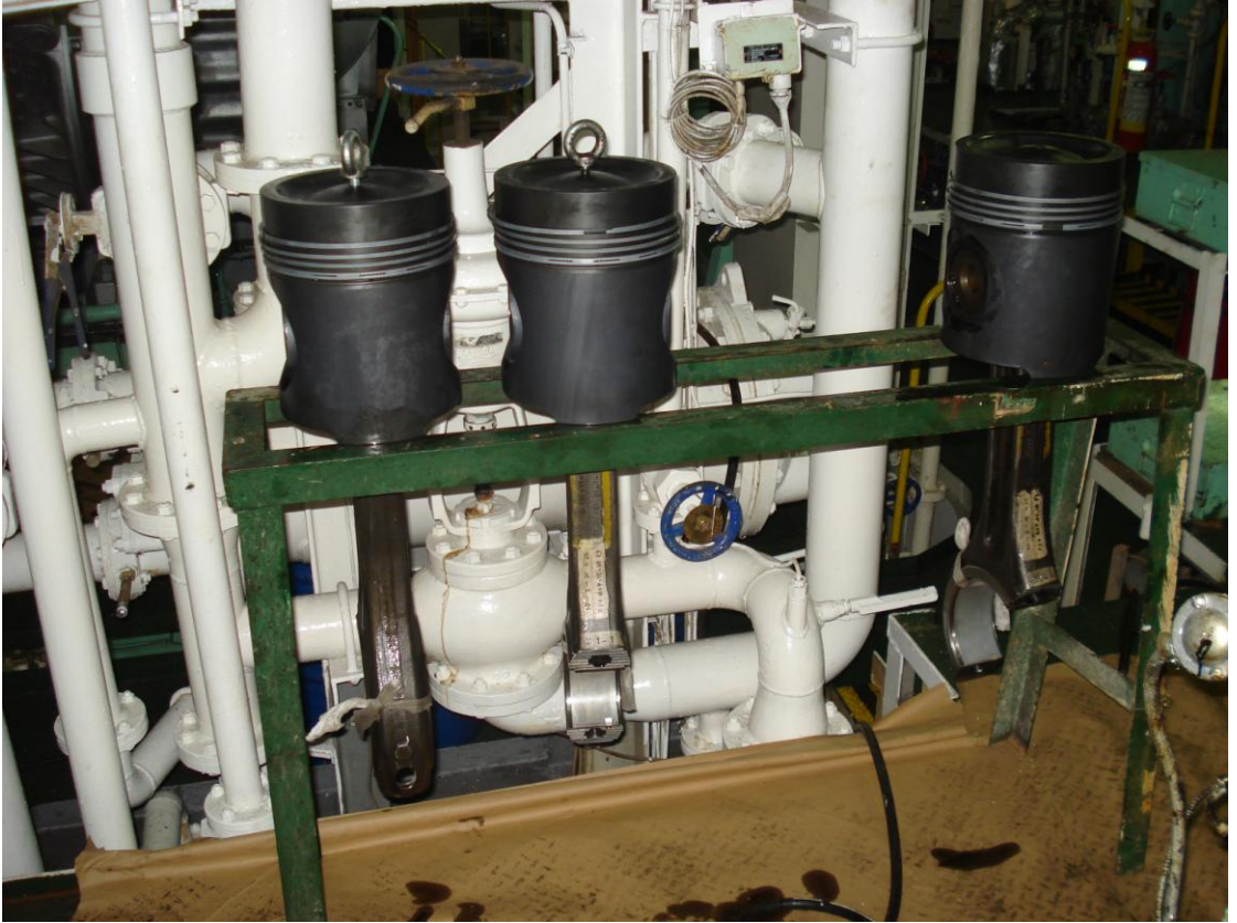
Şekil 3. 13 Overol İşlemi Sırasında Pistona Bağlanmış Konnektin Rod
