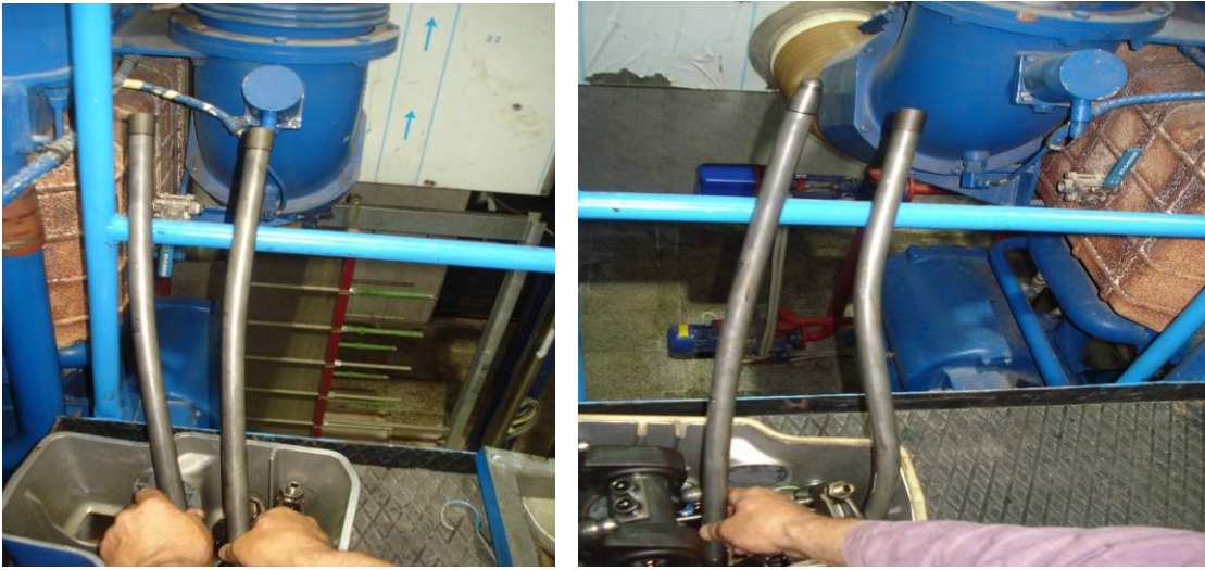
Şekil 6. 65 A2 ve B2 Silindirlerinin Supap İteceklerinin Eğilmesini Gösteren Resim
