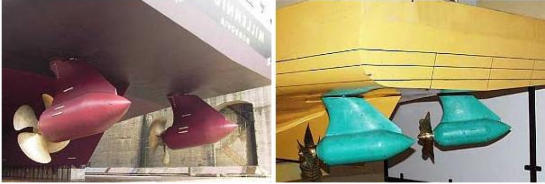
Şekil 2.1 Pervane ile modelinin geometrik benzerliğine bir örnek [1]
