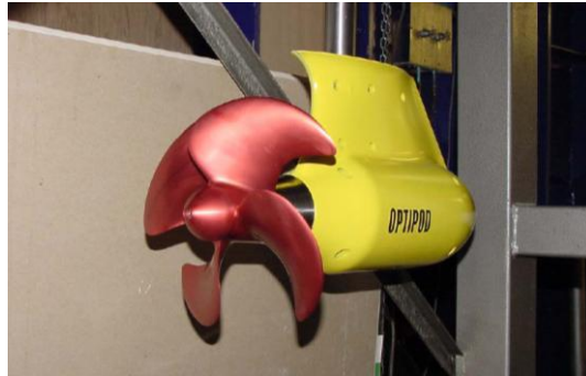
Şekil 4.1 Podlu pervane modeli (Wang vd., 2002)
