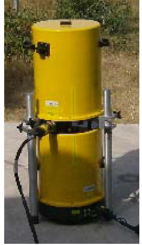
Şekil 3.2 Düşen cisim yardımıyla mutlak gravitenin belirlenmesi (solda), A10 model mutlak gravite ölçer (sağda)
