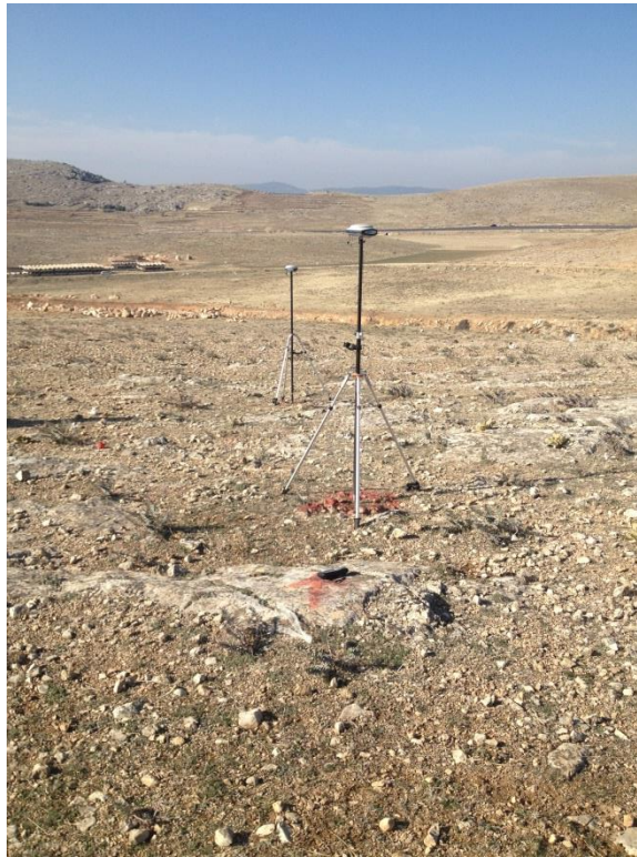
Şekil 5.2 Proje Alanında Post-Processing Kinematic Ölçümün Yapılması
