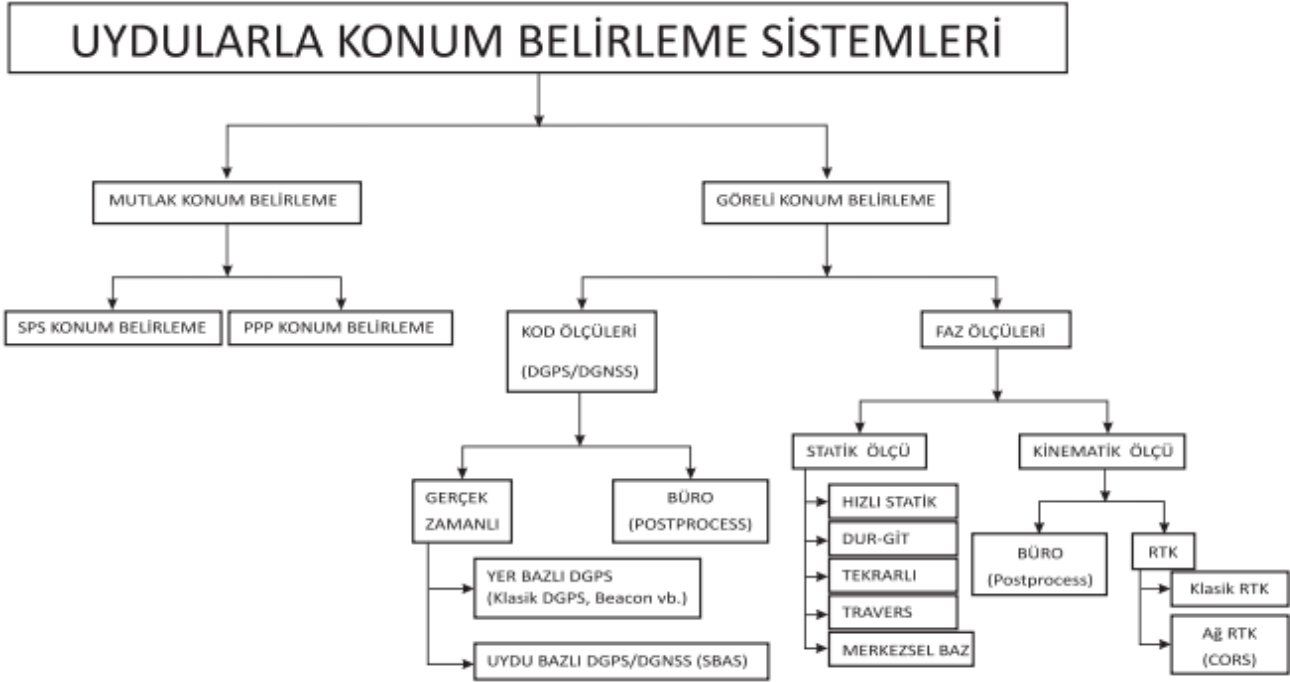
Şekil 3.1 GNSS konum belirleme yöntemleri [36]
