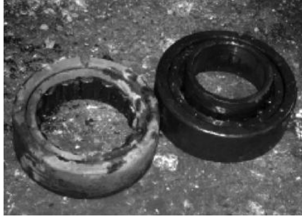
Şekil 5. 2 Yüksek sıcaklıktan dolayı hasarlanan bir rulman [32]
