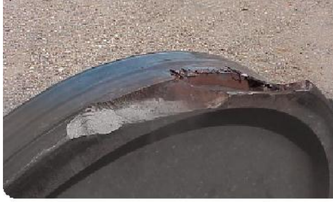
Şekil 5. 1 Yüksek sıcaklığa maruz kalarak aşınan demiryolu taşıt tekeri [32]
