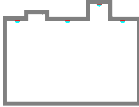
Şekil 3. 13 Girintili tavanlarda yangın dedektör yerleşimi[2]
