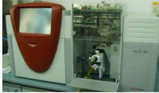
Şekil 3.9 Analytikjena markalı AA Atomik Absorpsiyon Spektrometresi
