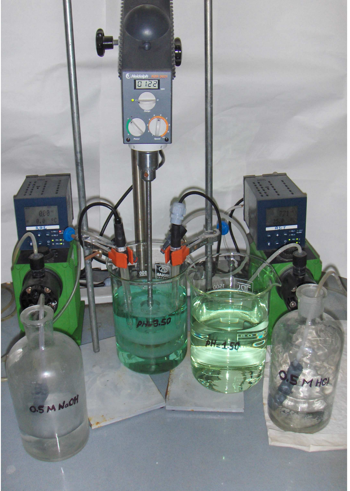
Şekil 3.2 pH değişimine bağlı iyon değiştirme (parapumping) yöntemi ile sulu çözeltilerden üçlü metal karışımlarının ayrılmasına yönelik dizayn edilen sistem (Bartosch vd., (2000)' e göre dizayn edilen sistem)
