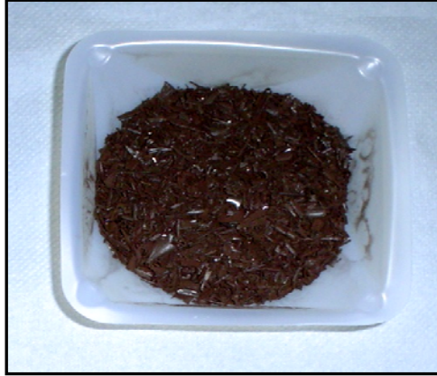
Şekil 3. 1 Connolly-GPM firmasından temin edilen sıfır değerlikli demir (IRON AGGREGATE ETI CC-1004)
