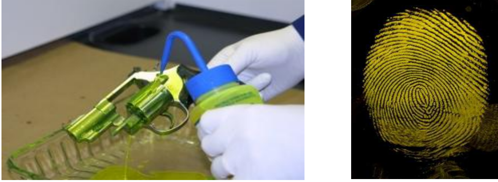
Şekil 3. 14 R6G uygulaması ve gözlemlenen parmak izi
