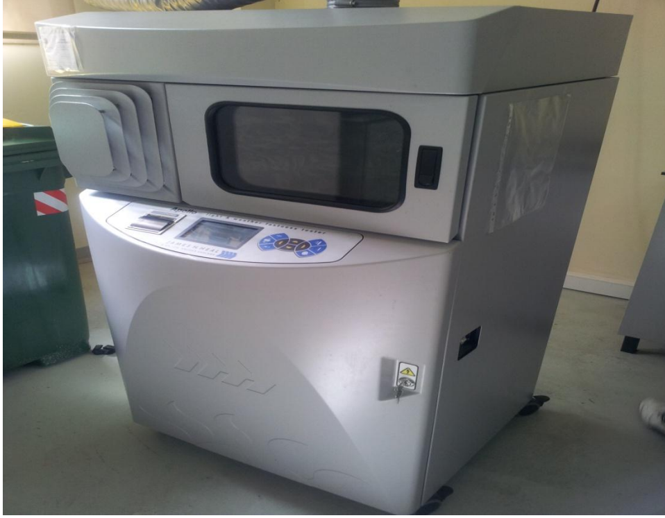
Şekil 4.2 700 Apollo James (H. Heal & Co. Ltd) ışık haslığı test cihazı
