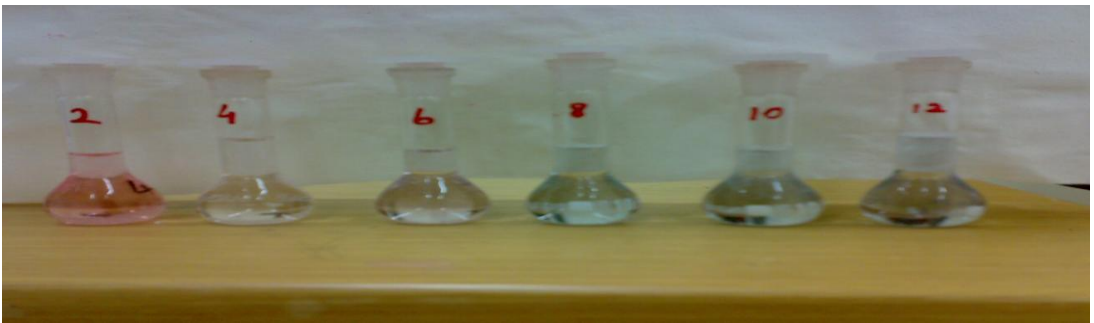
Şekil 5.21 Standart antosiyanin çözeltisinin pH ile renk değişiminin incelenmesi
