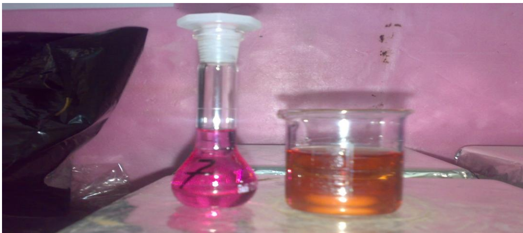
Şekil 5.25 H 2 O 2 ile bozundurulmuş gül ekstresinin 5 dakika sonundaki renk değişimi
