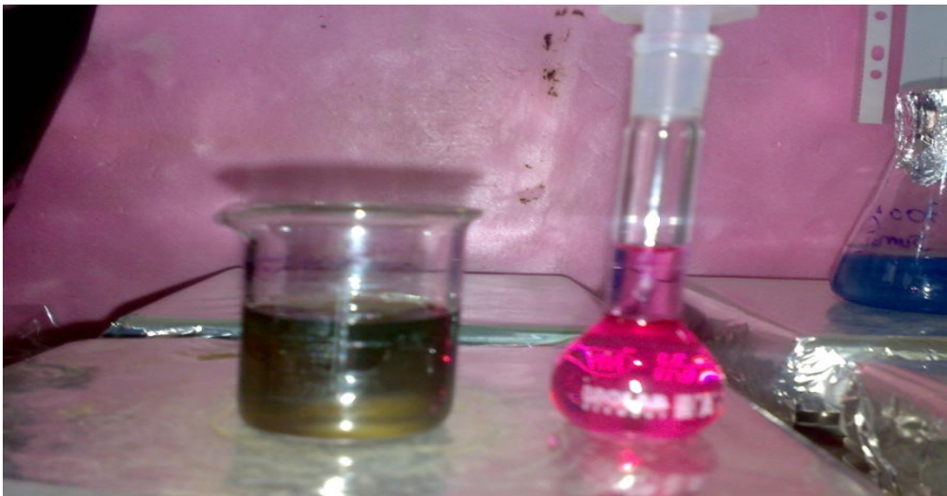
Şekil 5.27 NaNO 2 ile bozundurulmuş gül ekstresinin 5 dakika sonundaki renk değişimi
