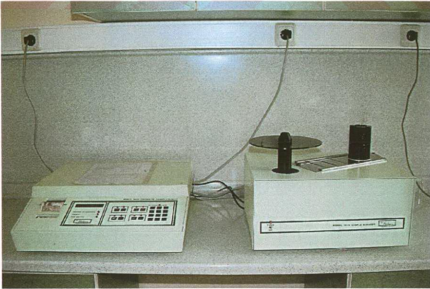
Şekil 5.1 Radyokimyasal saflık kontrolünde kullandığımız NaI(Tl) dedektörlü gama sayıcı
