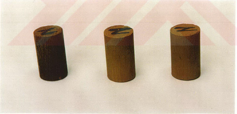
Şekil 10.3. (a) 1000 °C, (b) 1030 °C ve (c) 970 °C’de pişirilen % 10 boraks atığı katkılı kil numuneleri
