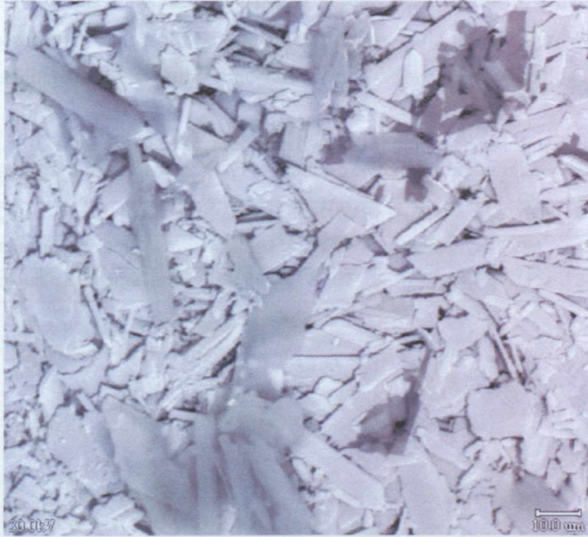
Şekil 4.17 Katkı maddesi olarak 0,25 ppm EDTMP kullanıldığı durumda CaSO 4 ·2H 2 O kristallerinin 750 büyütme derecesinde SEM görüntüleri
