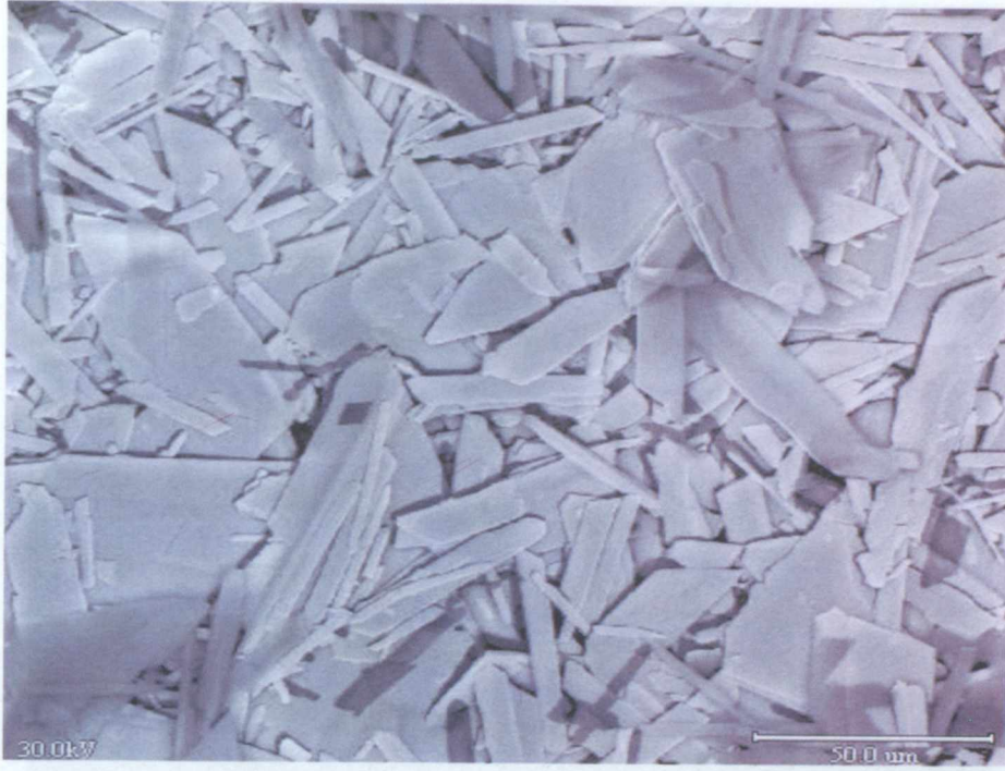
Şekil 4.12 Katkı maddesi kullanılmadığı durumda CaSO 4 ·2H 2 O kristallerinin 500 büyütme derecesinde SEM görüntüleri
