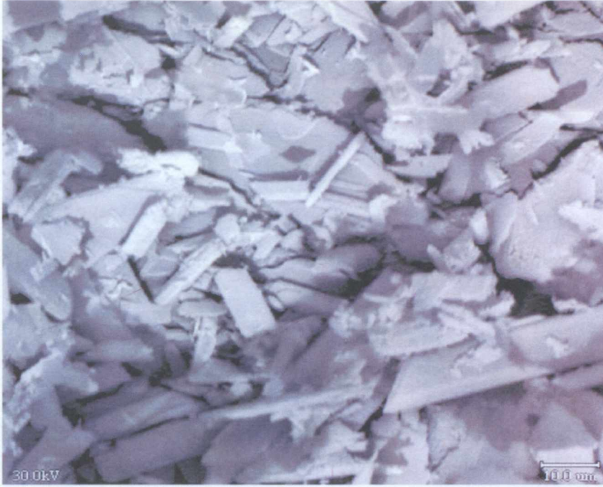
Şekil 4.18 Katkı maddesi olarak 0,25 ppm EDTMP kullanıldığı durumda \text{CaSO}_4 \cdot 2\text{H}_2\text{O} kristallerinin 1000 büyütme derecesinde SEM görüntüleri
