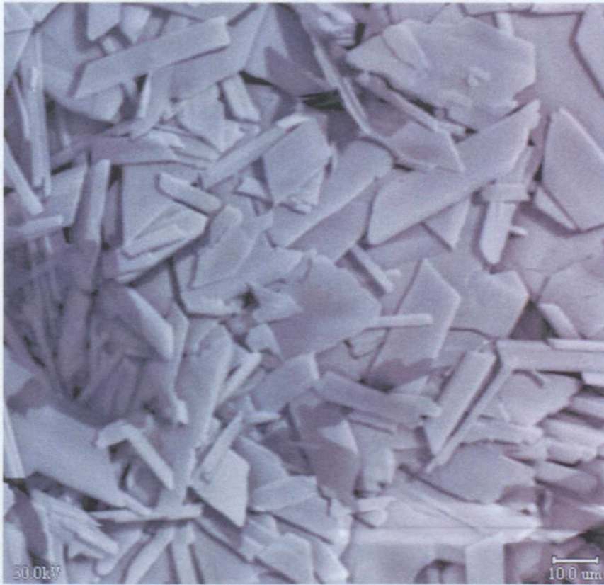
Şekil 4.15 Katkı maddesi olarak 0,1 ppm NaPC kullanıldığı durumda CaSO 4 ·2H 2 O kristallerinin 750 büyütme derecesinde SEM görüntüleri
